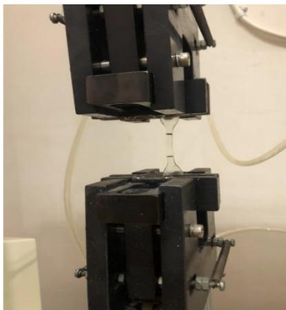
Gambar 2.4. Proses pengujian Tarik.
