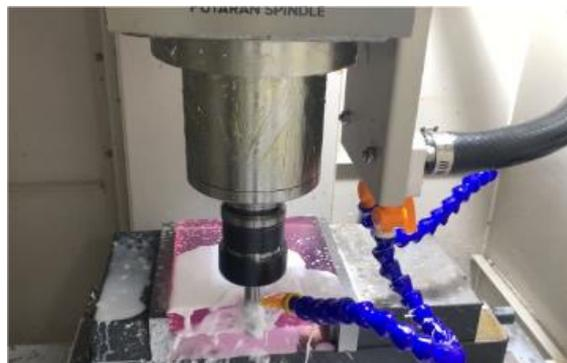
Gambar 4- 20 Proses Pemakanan Resin
