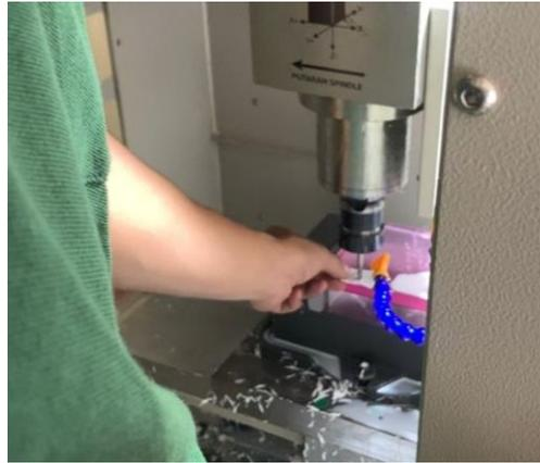
Gambar 4- 21 Pengaturan *Origin* untuk Prototipe
