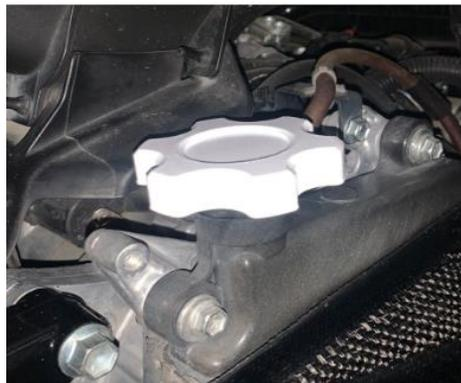
Gambar 4- 2 Prototipe 3D print produk terpasang
