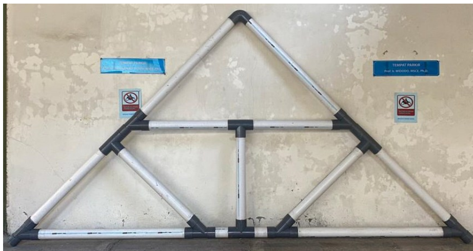
Gambar 4.19 Hasil Perakitan Kuda-Kuda Model 1
