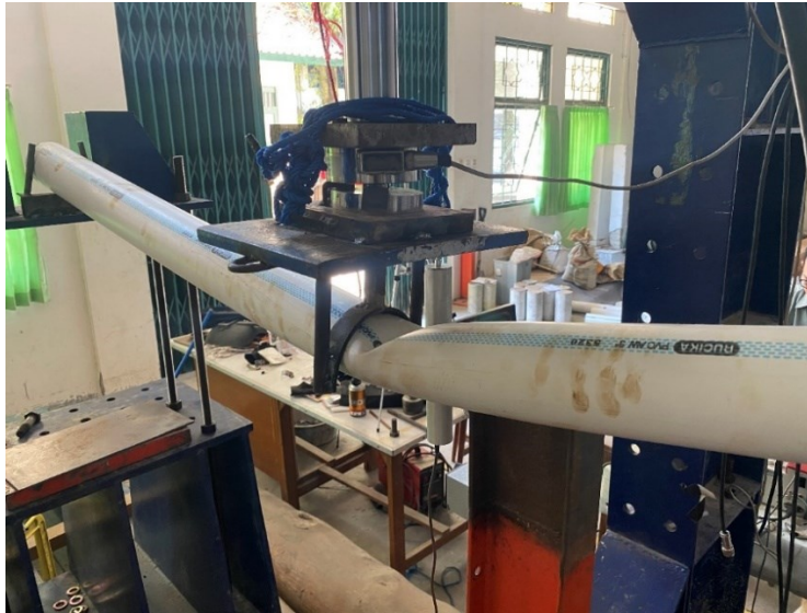
Gambar 5. 19 Kondisi Sampel 2 Bentang 2 meter Setelah Diuji Lentur
