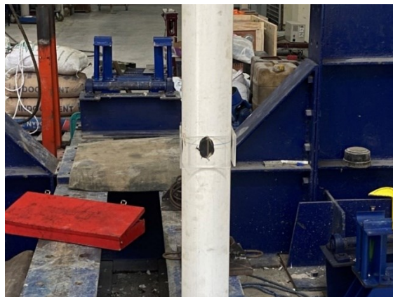
Gambar 5. 2 Pemasangan Akrilik Pada Sampel Pipa
