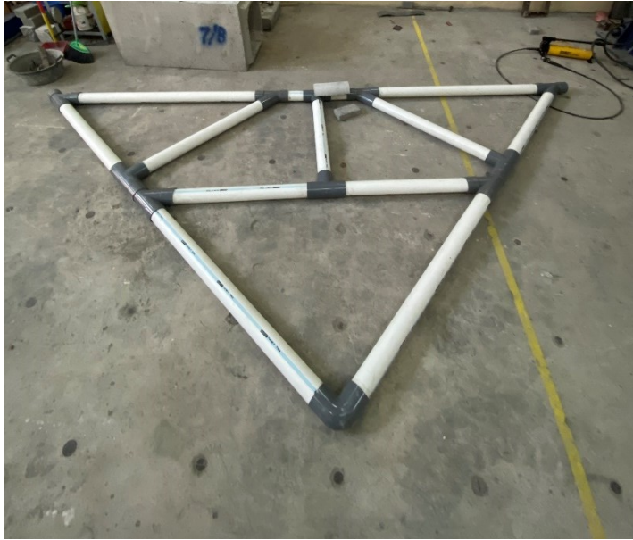
L-6 5. Kondisi Kuda-Kuda Setelah Dilakukan Uji Coba Pertama Kali
