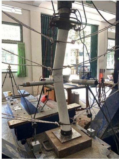
Gambar 5. 4 Kondisi Sampel 1 Setelah Dilakukan Uji Tekan
