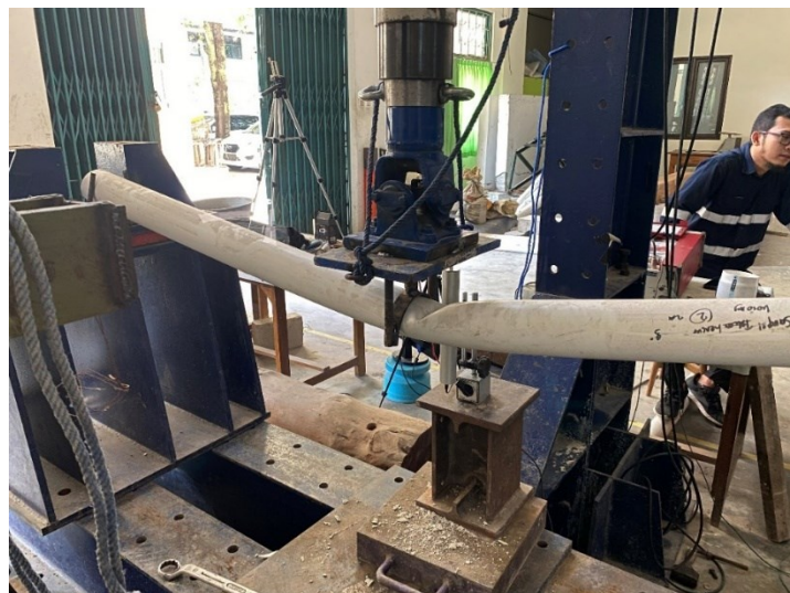
Gambar 5. 17 Kondisi Sampel 2 Bentang 2 meter Setelah Diuji Lentur
