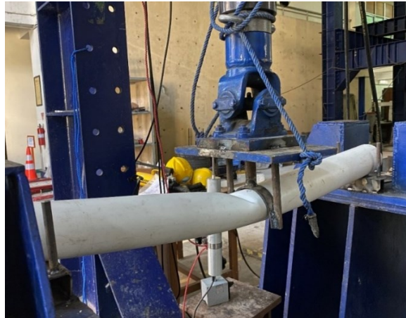
Gambar 5. 11 Kondisi Sampel 1 Bentang 1 Meter Setelah Diuji Lentur
