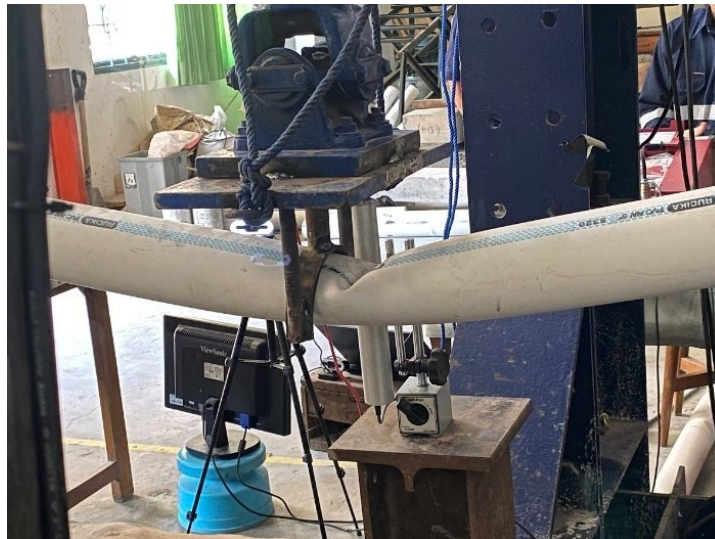
Gambar 5. 15 Kondisi Sampel 1 Bentang 2 meter Setelah Diuji Lentur
