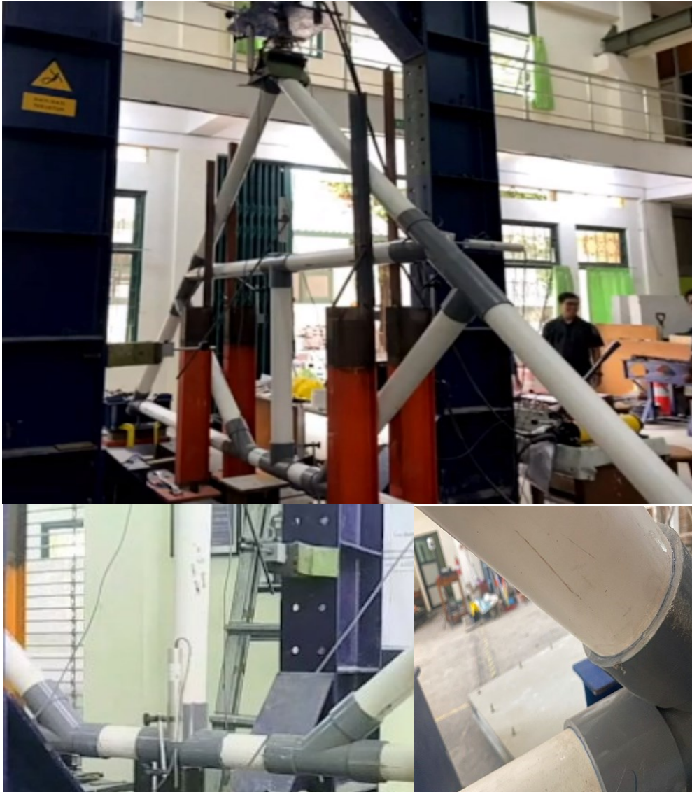
Gambar 5. 27 Kondisi Sampel Model 1 Setelah Diuji
