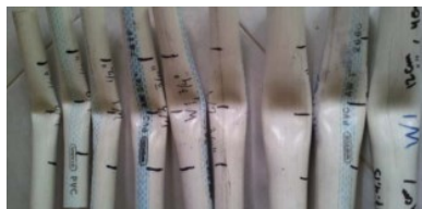
Gambar 2.1 Kondisi Pipa Merk W Setelah Uji Lentur
