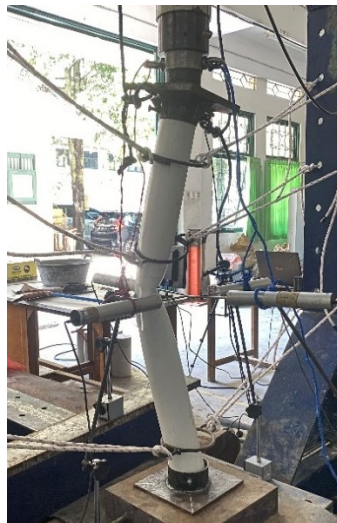
Gambar 5. 6 Kondisi Sampel 2 Setelah Dilakukan Uji Tekan
