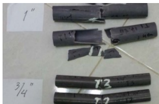
Gambar 2.2 Kondisi Pipa Tanpa Merk Setelah Uji Lentur
