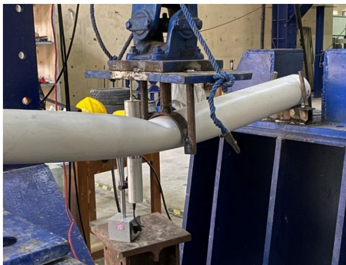
Gambar 5. 13 Kondisi Sampel 2 Bentang 1 meter Setelah Diuji Lentur
