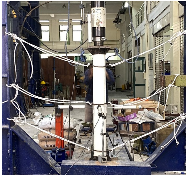
Gambar 4.15 Setting Pengujian Tekan
