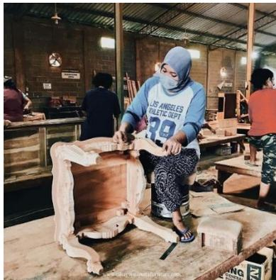
**Gambar 2.5 Proses Pengampelasan**
