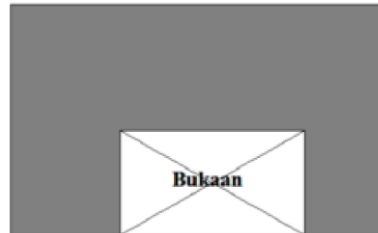
Gambar 3.19 Ketidakberaturan Diskontinuitas Diafragma
