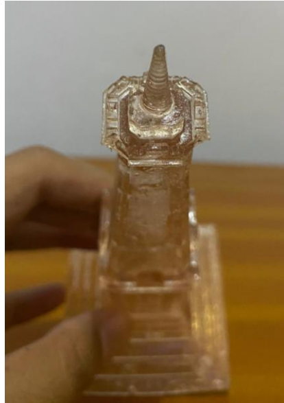
Gambar 4- 32 Kegagalan Akibat Gelembung
