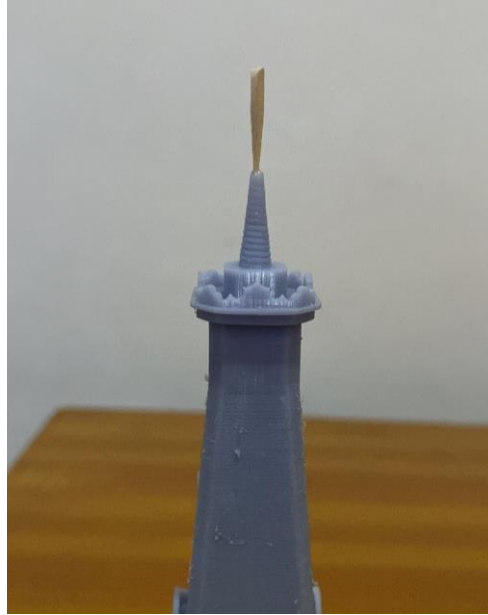
Gambar 4- 31 Penambahan Kayu Pada Master
