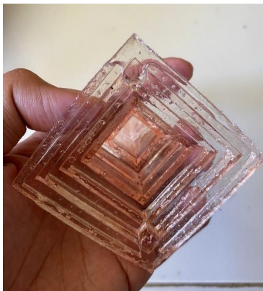
Gambar 4- 33 Kegagalan Akibat Gelembung
