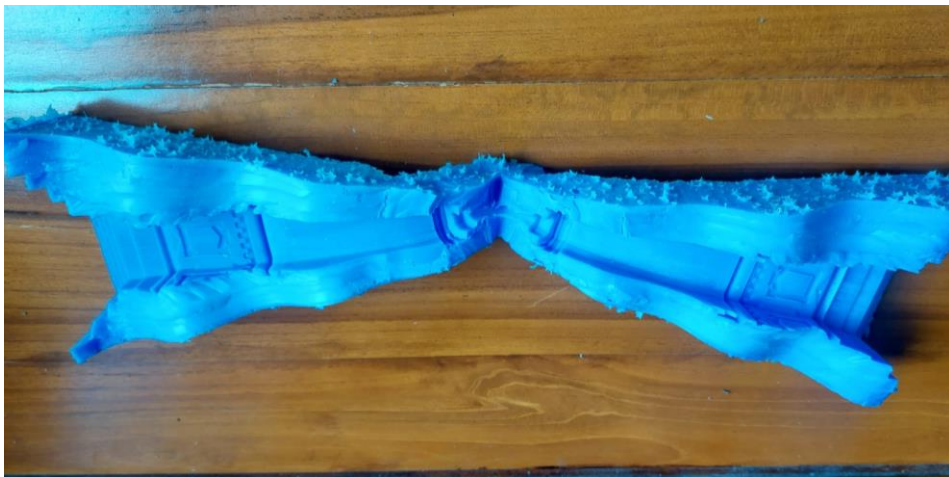
Gambar 4- 36 Cetakan Silikon Sudah Tidak Rekat
