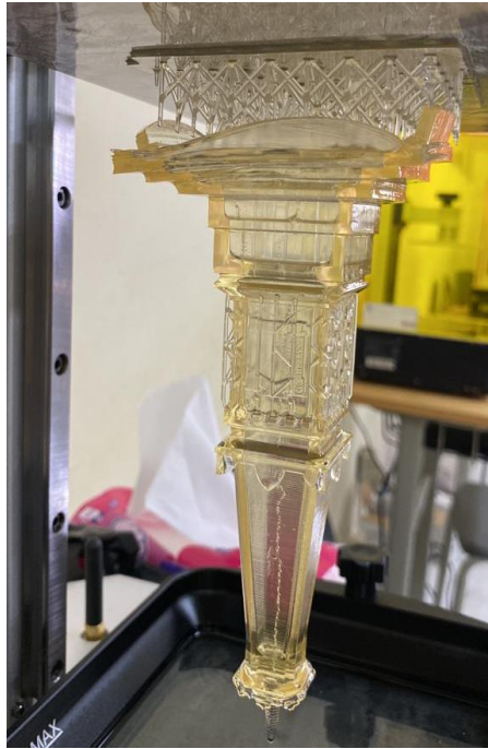
Gambar 4- 13 Kegagalan Pada Bagian Support
