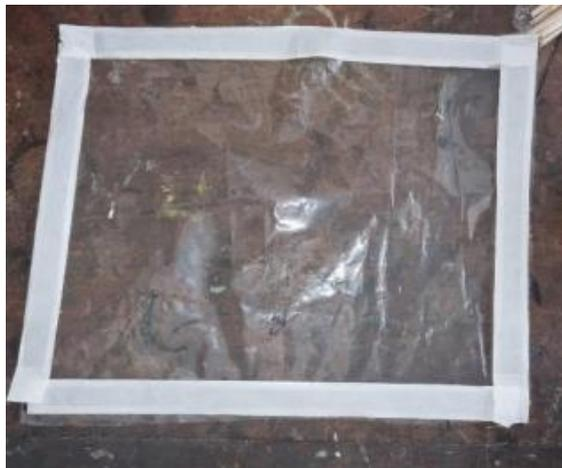
Gambar 3-29 Pemasangan *Sealent Tape*
