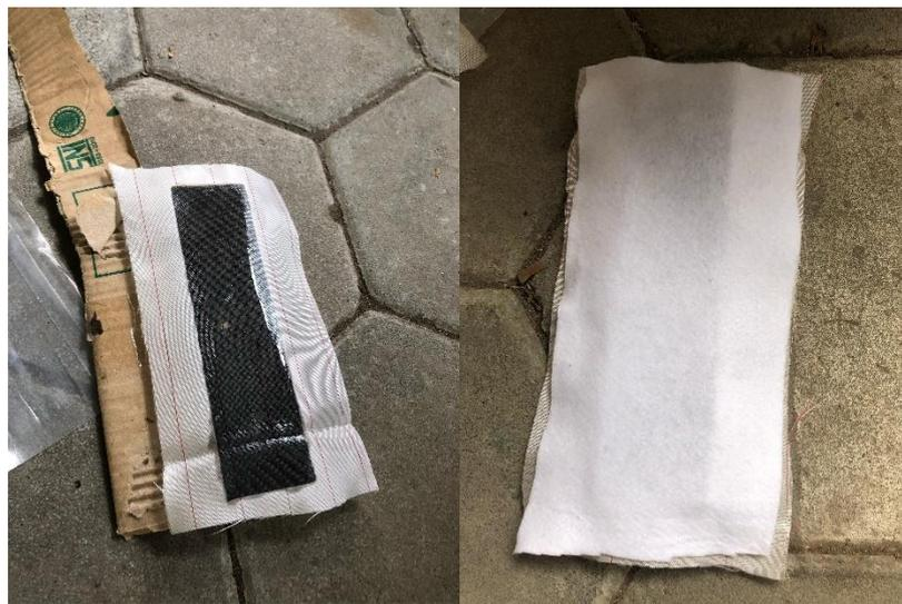
Gambar 3-31 Penempelan *Peel Ply* dan Kain *Breathe Bleeder*
