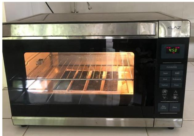
Gambar 3-35 Proses *Curing* Spesimen
