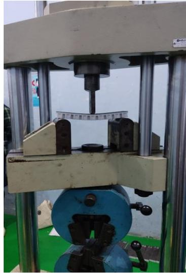
Gambar 2-4 Pengujian *Bending*
