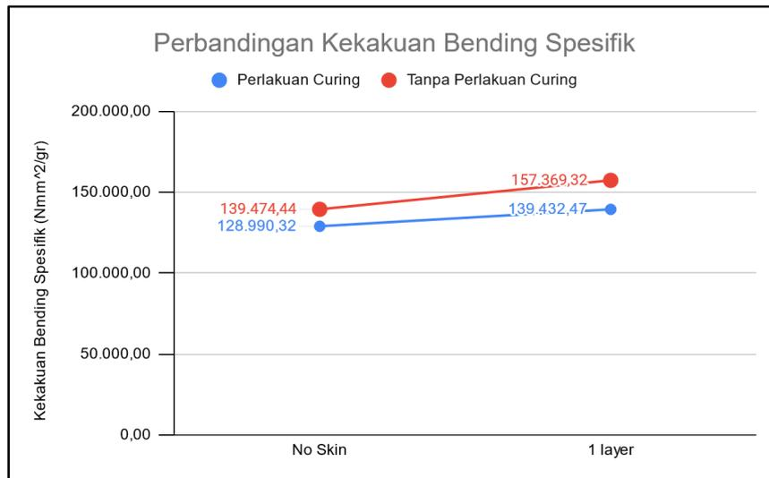
Gambar 4-20 Grafik Perbandingan Kekakuan *Bending* Spesifik
