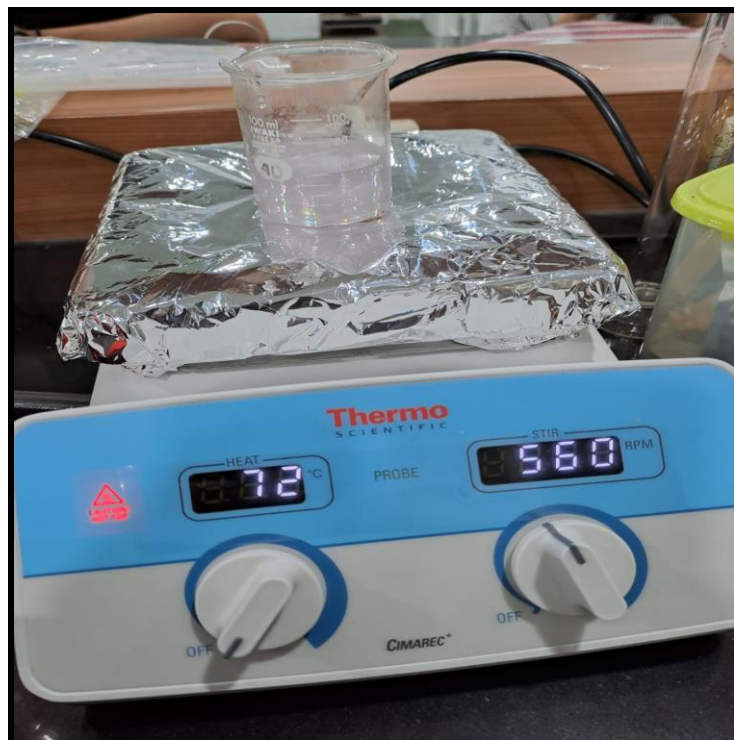
Gambar Lampiran 2.6 Proses stirer larutan resin setelah di tambahkan UV
