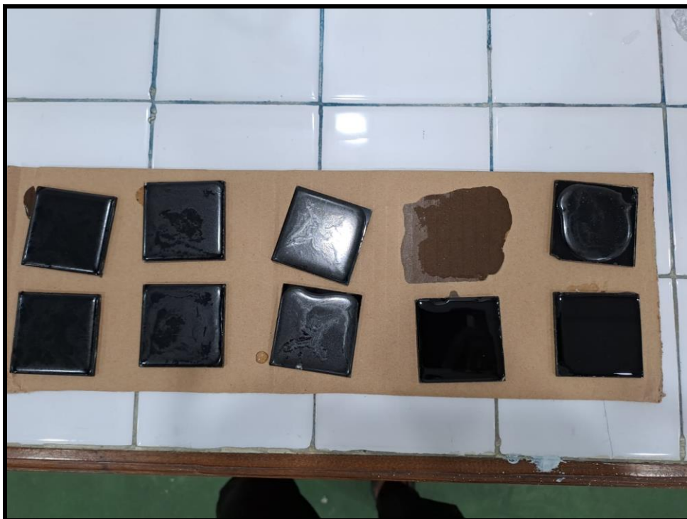
Gambar Lampiran 2.8 Sampel resin yang di tuang pada kaca setelah curing
