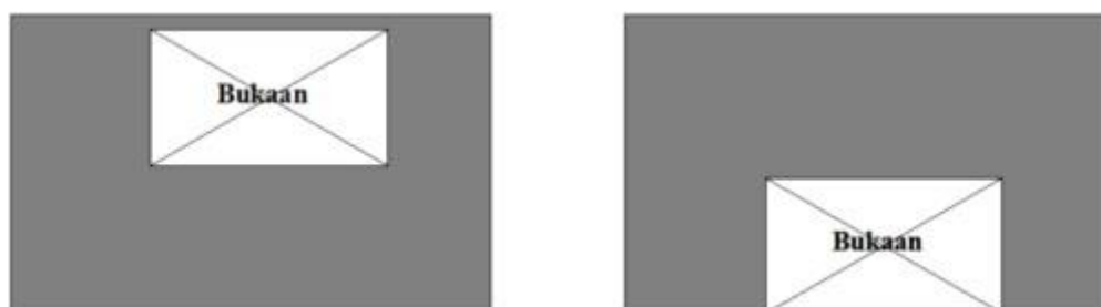
Gambar 3.3 Ketidakberaturan Diskontinuitas Diafragma
