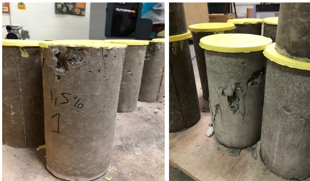
Gambar L-4. 4 Benda Uji setelah Pengujian Kuat Tekan
