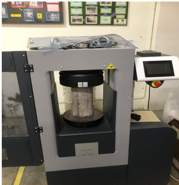
Gambar L-4. 2 Pengujian Kuat Tekan Beton
