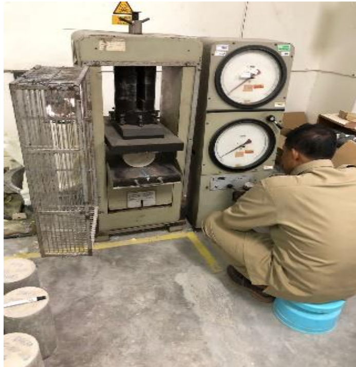
Gambar L-4. 3 Pengujian Kuat Tarik Beton
