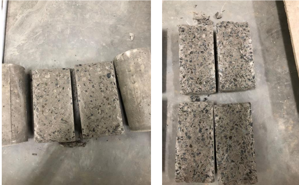
Gambar L-4. 5 Benda Uji setelah Pengujian Kuat Tarik
