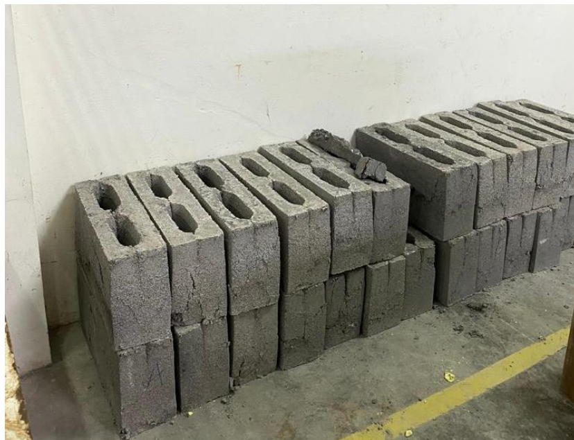
Gambar L 5.2 Batako Bubur Kertas setelah uji Kuat Tekan
