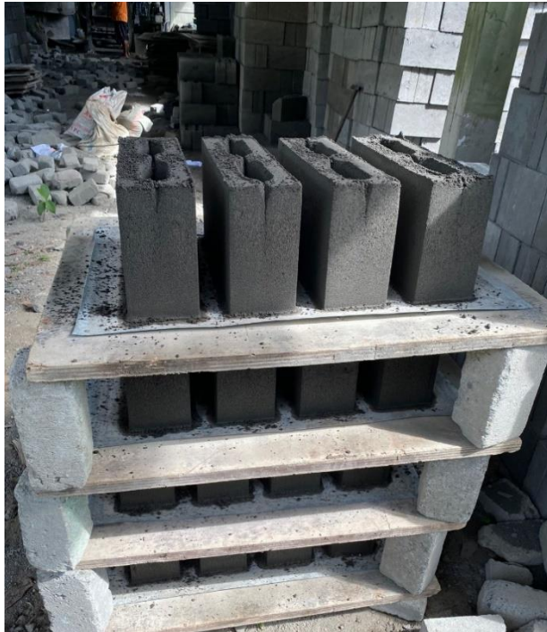
Gambar L 4.1 Batako Bubur Kertas setelah dicetak
