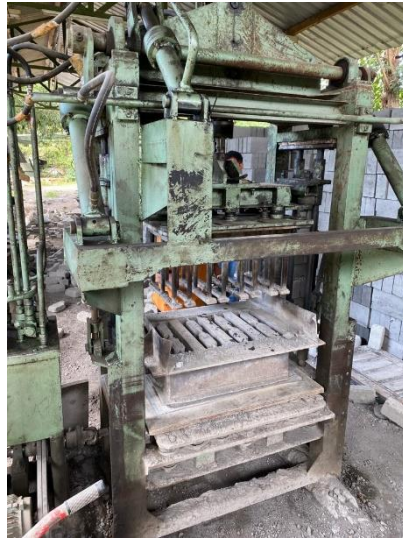
Gambar 4.2 Alat Press Batako
