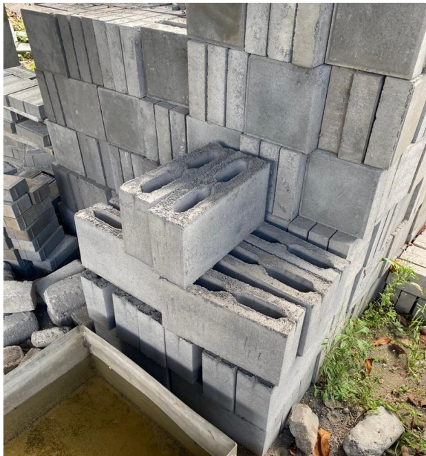
Gambar L 4.2 Batako Bubur Kertas yang sudah kering
