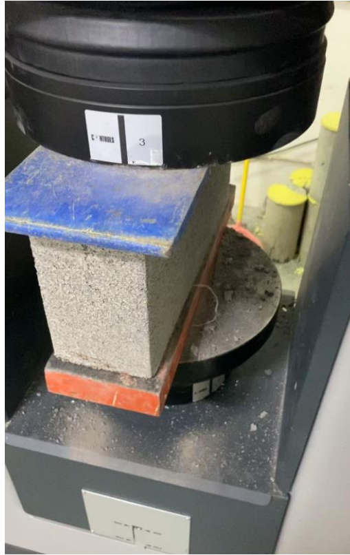
Gambar L 5.1 Pengujian Kuat Tekan Batako Bubur Kertas
