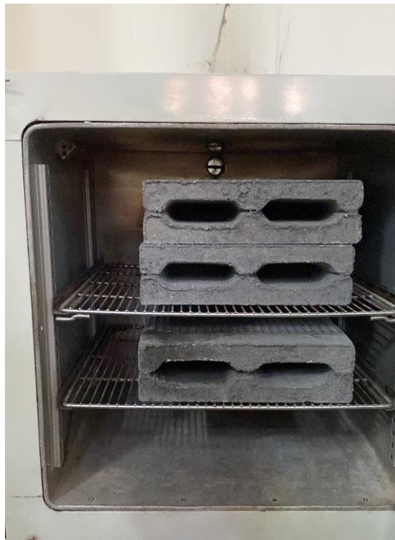
Gambar L 6.2 Batako Bubur Kertas saat di Oven
