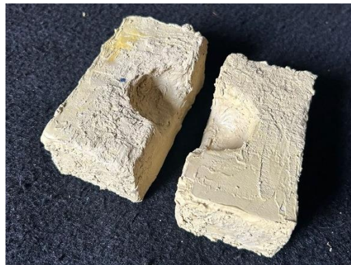
Gambar 4-4 Hasil Proses Pendempulan Puzzle Mold Komposit
