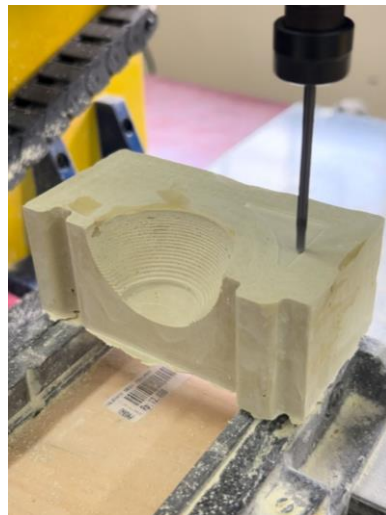
Gambar 3-27 Proses Permesinan Puzzle Mold Komposit
