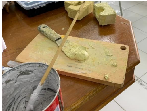
Gambar 3-25 Proses Pendempulan Puzzle Mold Komposit
