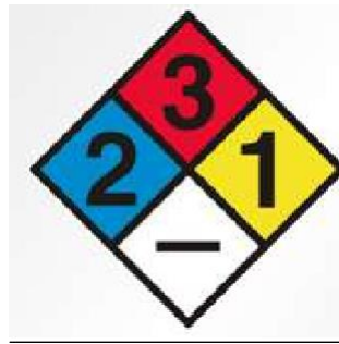
Gambar 2. 1 Hazard Diamond pada MIBK
