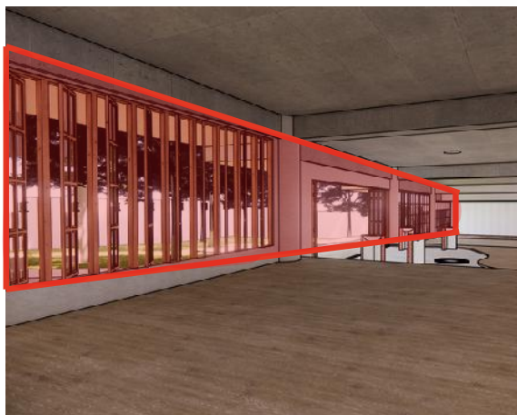
Gambar 3.39 Jendela Pivot sebagai Pengatur Intensitas Angin yang Masuk ke Dalam Gedung
