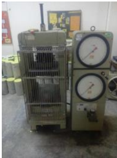
Gambar 4.5 Pengujian Kuat Tekan Beton dengan Alat Compressing Test Machine
