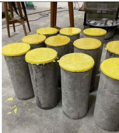
Kaping Benda Uji
