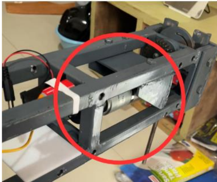
Gambar 4. 2 Motor PG45 Terhubung antara gear dengan mekanisme Scoth Yoke
