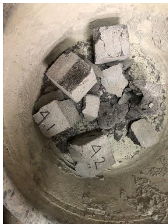
Gambar L-5.6 Hasil Pengujian Kuat Tekan Varian Bata Merah 5%;Plastik PET 0,4%
