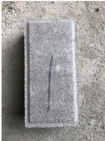
Gambar L-5.10 Tampak Permukaan Paving Block Varian Bata Merah 5%;Plastik PET 0,1%
