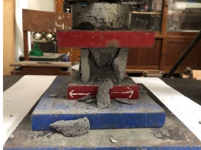
Gambar L-5.1 Hasil Pengujian Kuat Tekan Varian Bata Merah 0%;Plastik PET 0%
