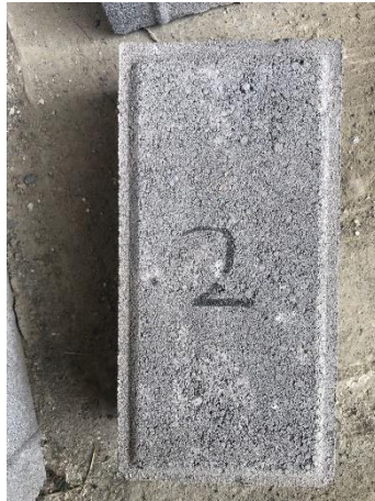
Gambar L-5.11 Tampak Permukaan Paving Block Varian Bata Merah 5%;Plastik PET 0,2%
