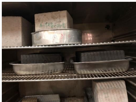
Gambar L-4.6 Proses Pengovenan Pengujian Daya Serap Air Paving Block
