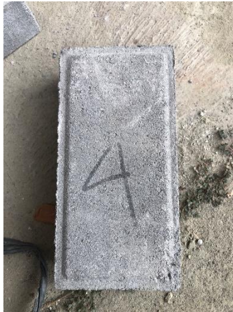
Gambar L-5.13 Tampak Permukaan Paving Block Varian Bata Merah 5%;Plastik PET 0,4%
