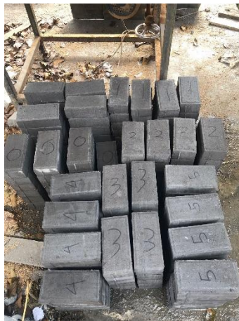
Gambar L-3.5 Proses Pengeringan Paving Block
