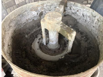
Gambar L-3.1 Pencampuran Bahan Penyusun Paving Block
