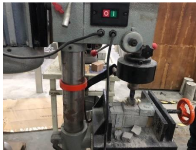
Gambar L-4.2 Proses Pengujian Ketahanan Aus Paving Block
