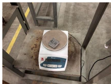
Gambar L-4.3 Proses Penimbangan Pengujian Ketahanan Aus Paving Block
