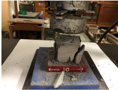
Gambar L-5.7 Hasil Pengujian Kuat Tekan Varian Bata Merah 5%;Plastik PET 0,5%
