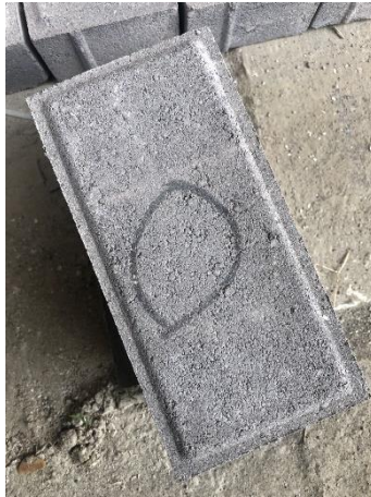
Gambar L-5.9 Tampak Permukaan Paving Block Varian Bata Merah 5%;Plastik PET 0%
