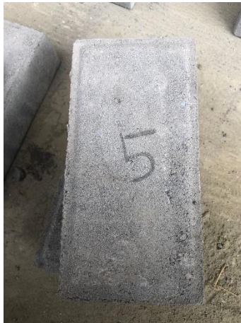
Gambar L-5.14 Tampak Permukaan Paving Block Varian Bata Merah 5%;Plastik PET 0,5%
