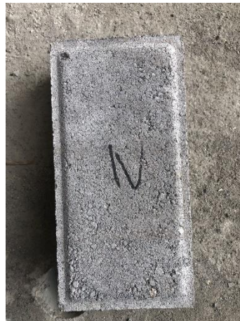
Gambar L-5.8 Tampak Permukaan Paving Block Varian Bata Merah 0%;Plastik PET 0%
