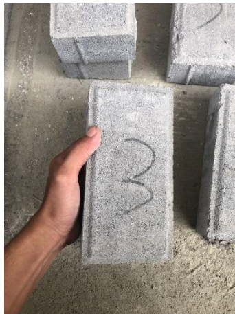
Gambar L-5.12 Tampak Permukaan Paving Block Varian Bata Merah 5%;Plastik PET 0,3%
