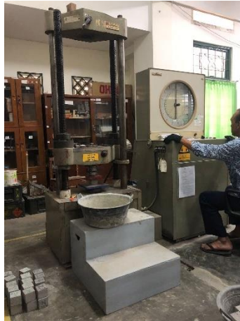
Gambar L-4.1 Proses Pengujian Kuat Tekan Paving Block
