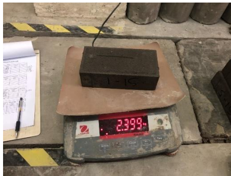
Gambar L-4.5 Proses Penimbangan Berat Sesudah Rendam Pengujian Daya Serap Air Paving Block
