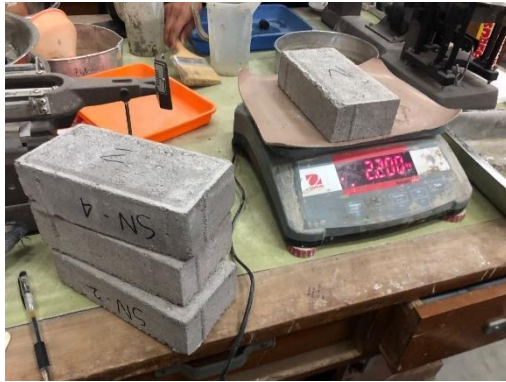
Gambar L-4.7 Penimbangan Berat Sesudah Oven Pengujian Daya Serap Air Paving Block
