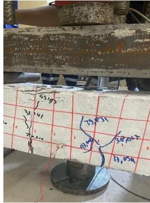
Gambar 5. 21 Detail Pola Keruntuhan BJ 02 – 3
