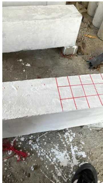
Gambar L-3. 6 Sampel Diberi Garis Kotak Dimensi 5 cm
