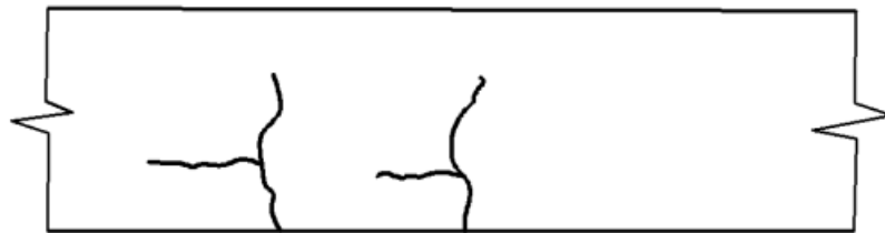
Gambar 3. 15 Ilustrasi Retak Lekatan
