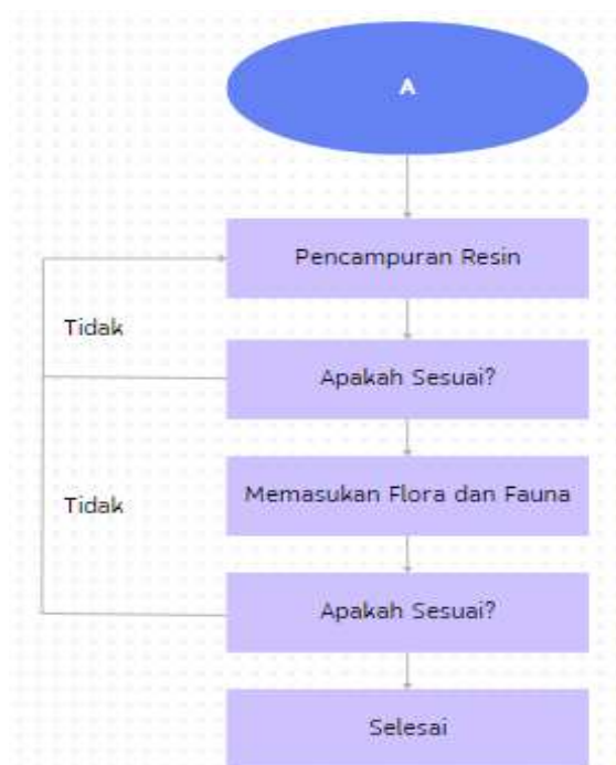
Gambar 3-2 Alur Pembuatan Batu Resin
