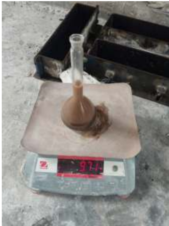
Lampiran 6.1 Penimbangan Piknometer Berisi Air dan Agregat Halus
