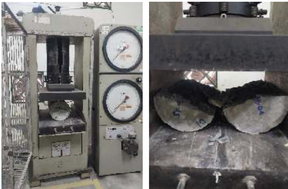
Gambar 5.12 Pengujian Kuat Tarik Belah dan Benda Uji Setelah Pengujian
