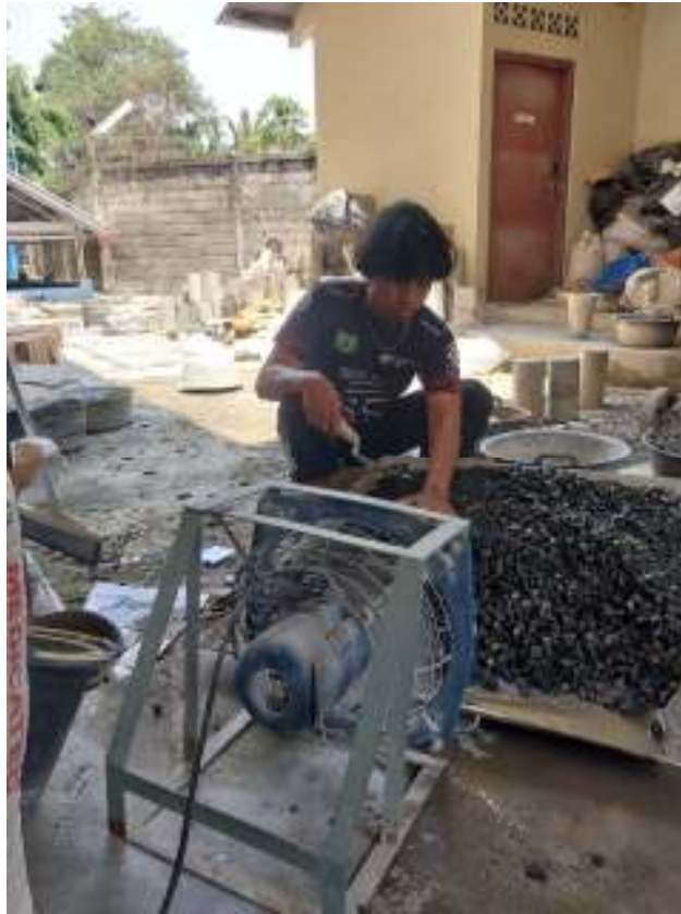
Lampiran 6.4 Pengkondisian SSD Pada Agregat Kasar
