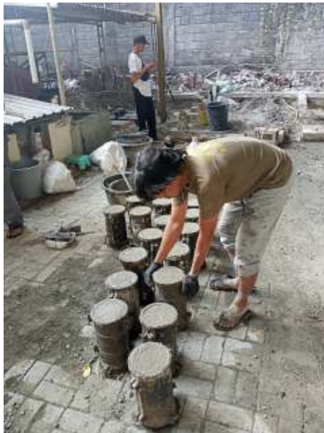
Lampiran 6.7 Penataan Benda Uji Setelah Dimasukkan Hasil Mix Beton
