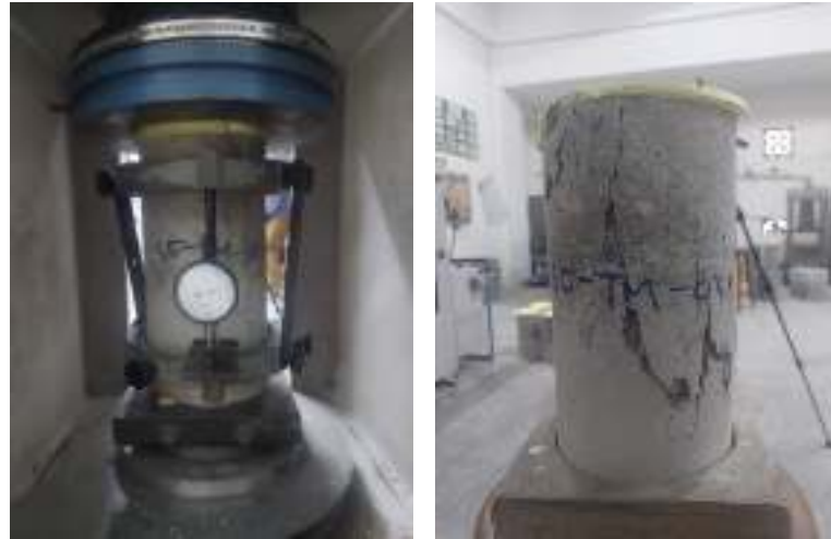
Gambar 5.10 Pengujian Kuat Tekan dan Benda Uji Setelah Pengujian
