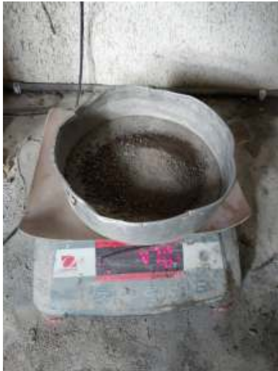
Lampiran 6.3 Penimbangan Agregat Halus Dalam Cawan
