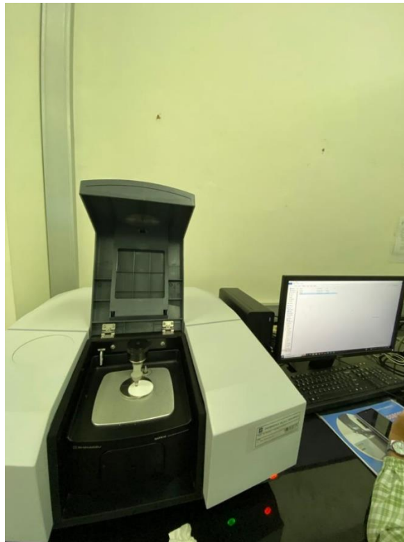
Gambar 3. 10 Pengamatan sampel menggunakan FTIR
