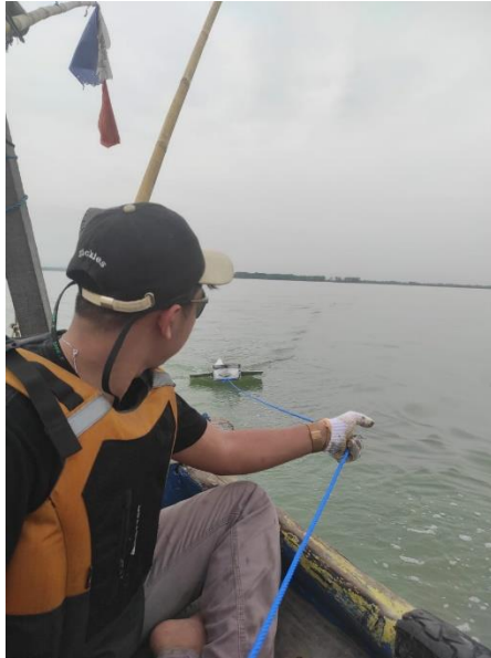
Gambar 3. 4 Pengambilan manta trawl
