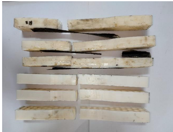
Gambar 4-2 Spesimen Setelah Uji Tarik
