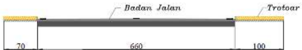
Gambar 4.32 Potongan Geometrik Ruas Jalan Perintis Kemerdekaan Barat
