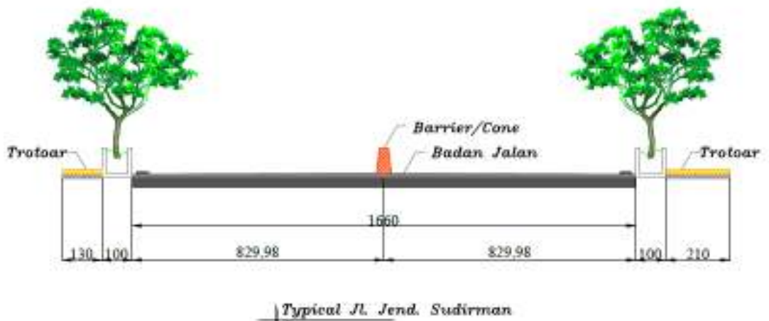
Gambar 4.12 Potongan Geometrik ruas Jalan Jenderal Soedirman (Segmen Simpang Masjid – Simpang Girisuman)
