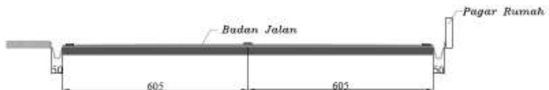
Gambar 4.66 Potongan Geometrik ruas Jalan Mayjend Sutoyo
