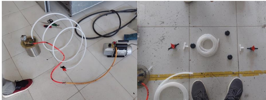
Gambar 3-31 Persiapan Pompa dan Rangkaian selang
