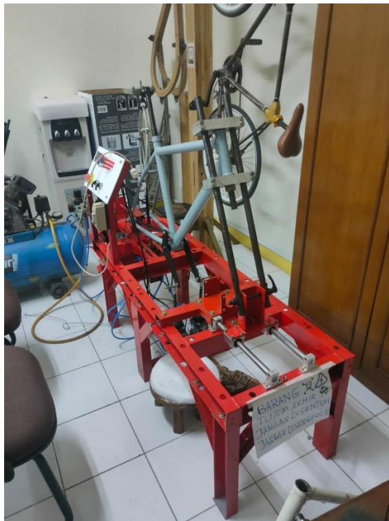
Gambar 4. 34 Hasil perancangan dan pembuatan alat uji rangka sepeda
