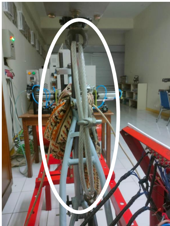
Gambar 4. 39 Pergantian sling dengan diameter yang lebih besar
