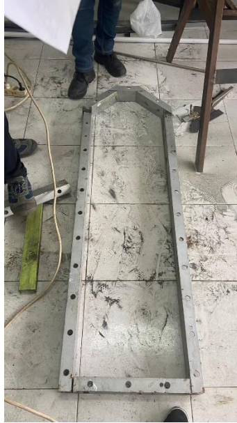
Gambar 4. 25 Proses perakitan besi UNP
