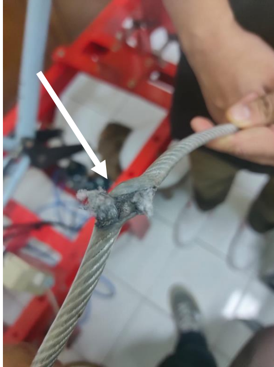
Gambar 4. 40 Sling terputus pada percobaan terakhir.
