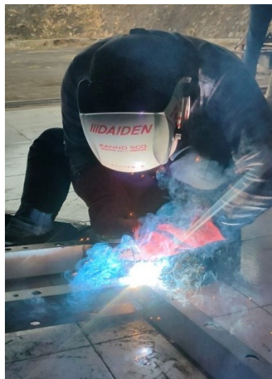
Gambar 4. 32 Proses Pengelasan Besi UNP
