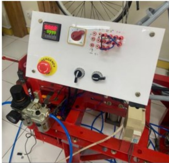
Gambar 4. 42 Kontrol Panel dengan Pin Konektor
