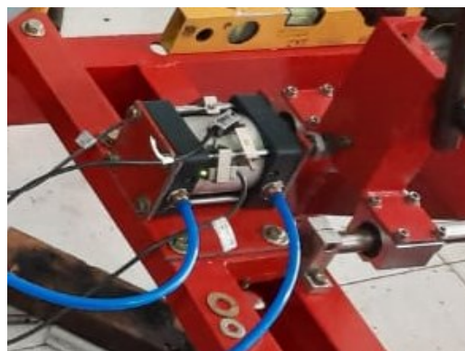
Gambar 4. 37 Percobaan Pengujian dengan Silinder Pneumatik 25mm
