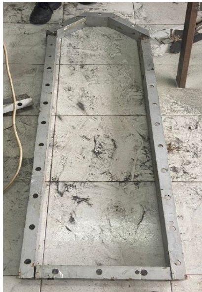
Gambar 4. 31 Proses Pensejajaran Besi UNP
