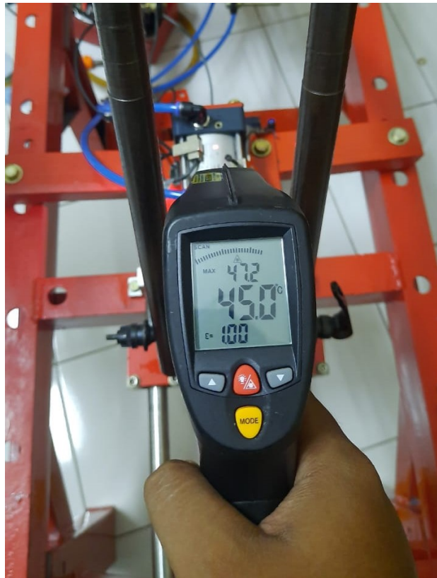
Gambar 4. 45 Pengecekan Suhu Silinder Pneumatik
