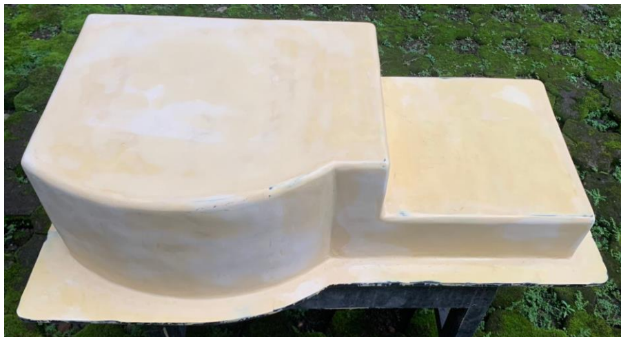
Gambar 4.13 Pola Cetakan Tampak Bawah Setelah proses Sanding
