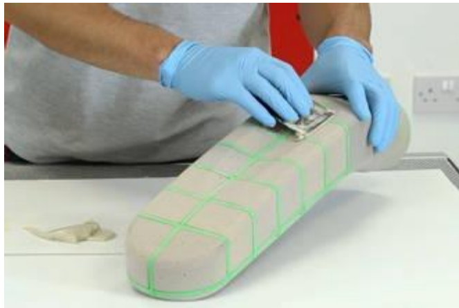
Gambar 1.1 Pola Konvensional Menggunakan Polyurethane Foam
