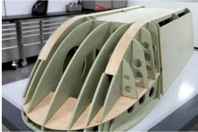
Gambar 1.2 Pola Konvensional Dengan Papan Susun
