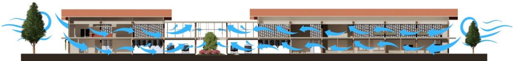
Gambar 120. Skema penghawaan yang masuk ke dalam bangunan
