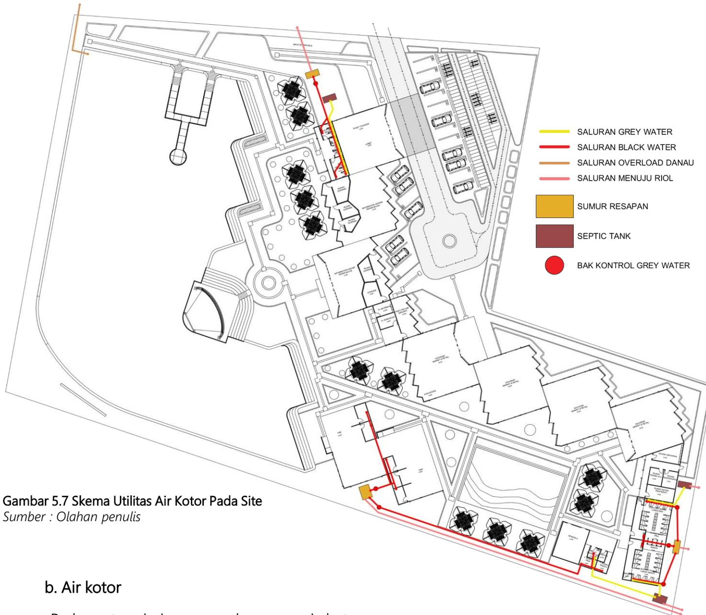
**Gambar 5.7 Skema Utilitas Air Kotor Pada Site**
