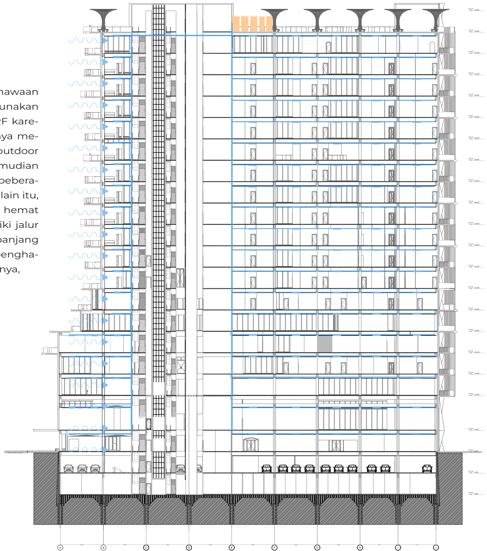
Gambar 5.75 Skema Penghawaan Alami dan Buatan
