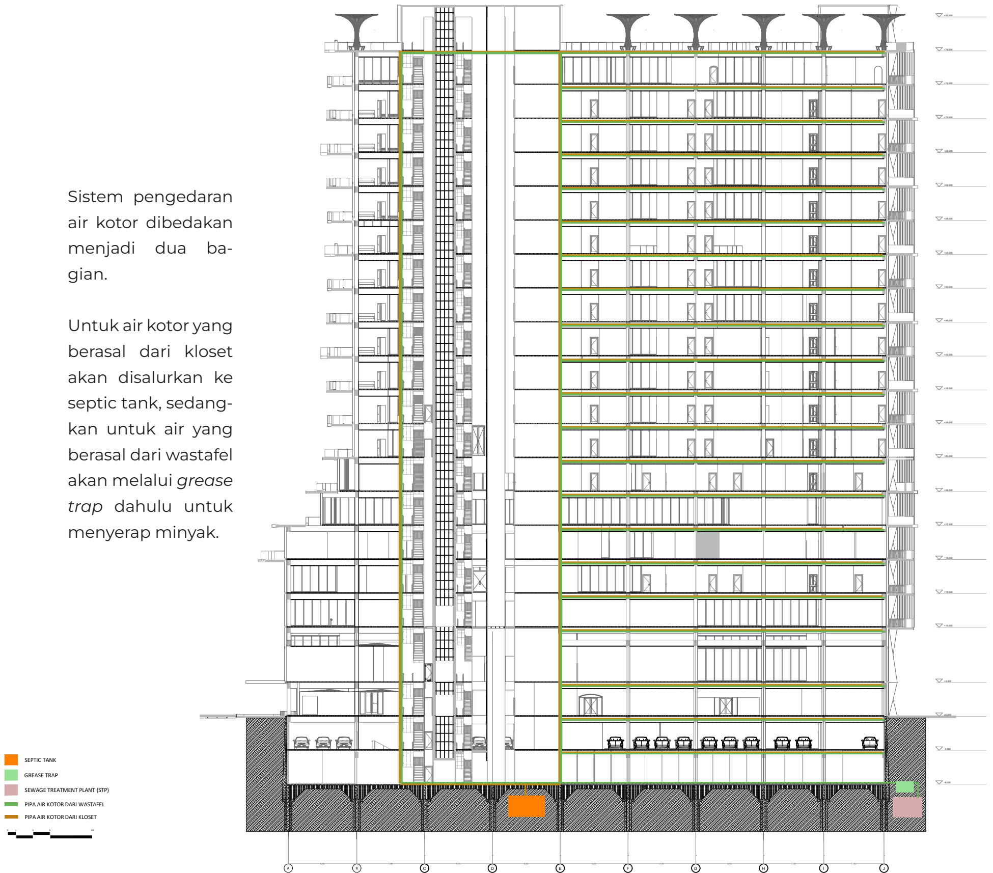
Gambar 5.73 Skema Air Kotor
