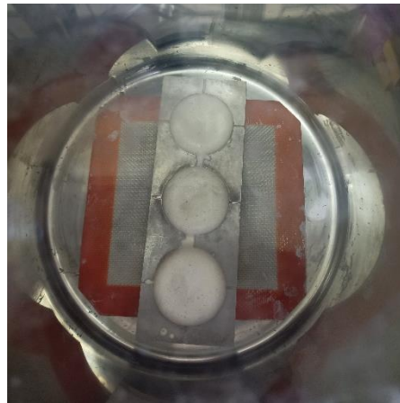
Gambar 3-20 Proses vakum kompon karet.
