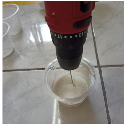
Gambar 3-18 Proses pengadukan campuran lateks.
