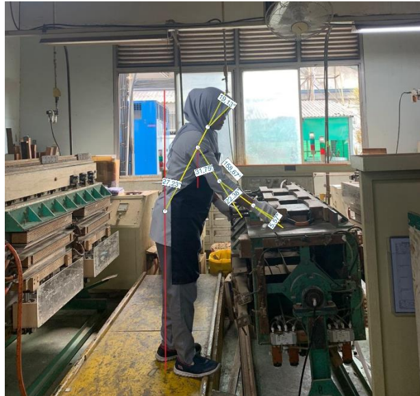
Gambar 4. 34 Foto Pekerjaan REBA
