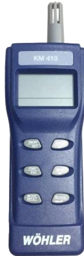
Gambar 2.1 Alat Indoor Air Quality Meter Wohler KM 410 (Sumber : Dokumentasi Pribadi, 2023)
