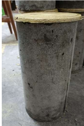
Gambar L-19.7 Pengujian Kuat Tekan Beton BRP57
