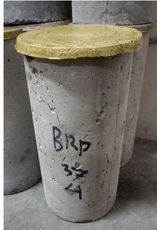
Gambar L-19.4 Pengujian Kuat Tekan Beton BRP37
