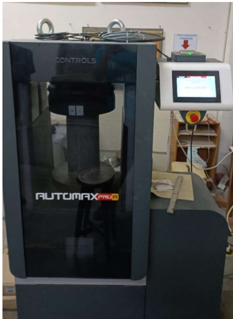
Gambar 4.8 Mesin Uji Kuat Tekan dan Tarik
