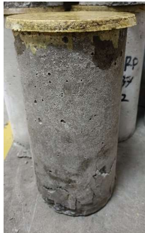
Gambar L-19.5 Pengujian Kuat Tekan Beton BRP53
