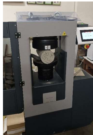
Gambar L-18.6 Pengujian Kuat Tarik
