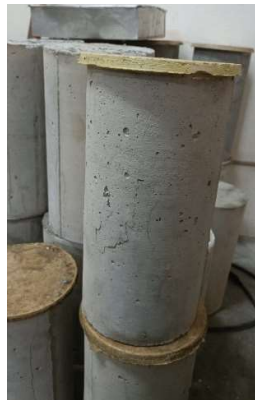
Gambar L-19.2 Pengujian Kuat Tekan Beton BRP33
