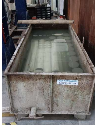
Gambar L-18.4 Perendaman Benda Uji
