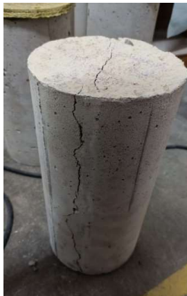
Gambar L-20.1 Pengujian Kuat Tarik Beton BN
