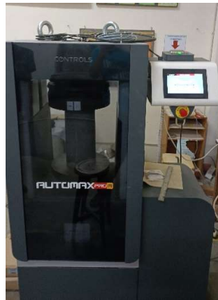
Gambar L-18.5 Pengujian Kuat Tekan
