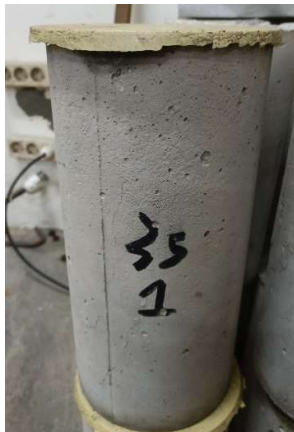
Gambar L-19.3 Pengujian Kuat Tekan Beton BRP35
