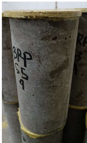
Gambar L-19.6 Pengujian Kuat Tekan Beton BRP55
