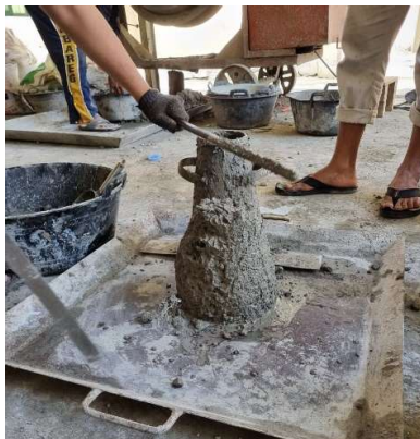
Gambar L-18.3 Pengujian Slump Benda Uji
