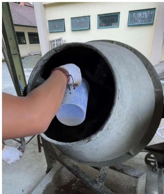
Gambar L-2.2 Proses Mencampur Bahan Tambah Superplasticizer Ke Dalam Mixer
