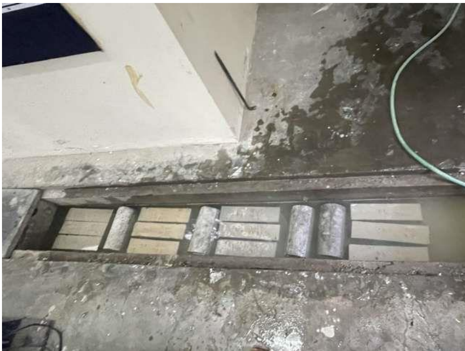
Gambar L-2.4 Perendaman Benda Uji
