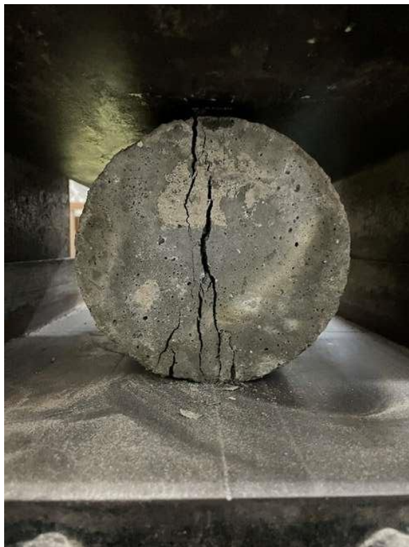
Gambar L-2.8 Pengujian Kuat Tarik Belah
