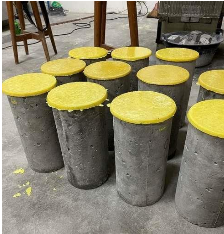
Gambar L-2.5 Kaping Benda Uji
