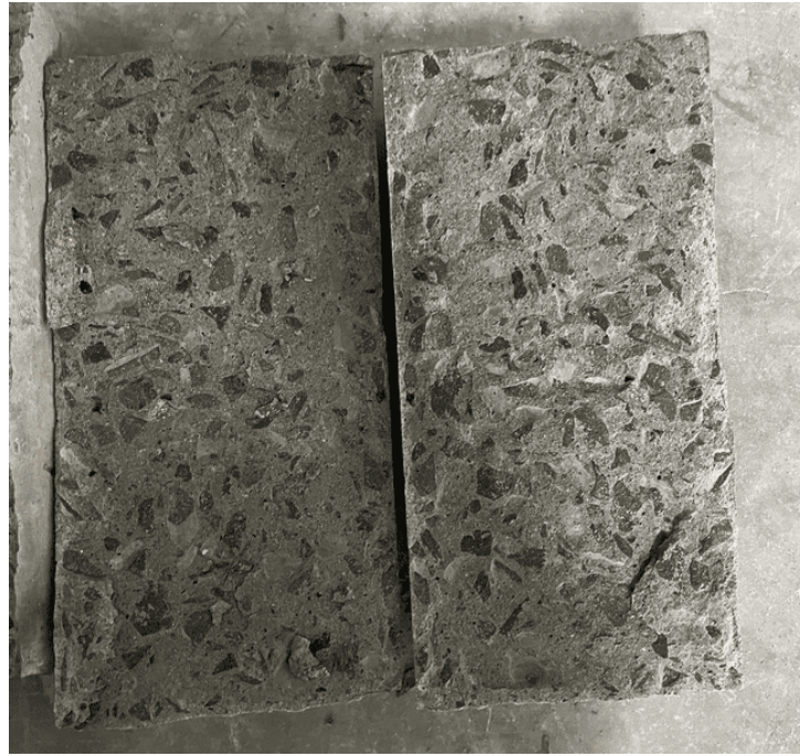
Gambar L-2.9 Hasil Pengujian Kuat Tarik Belah
