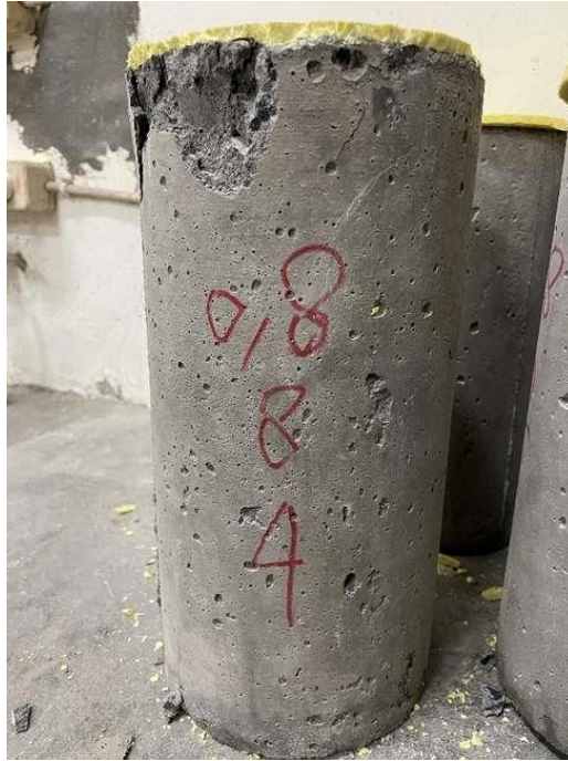
Gambar L-2.7 Hasil Pengujian Kuat Tekan
