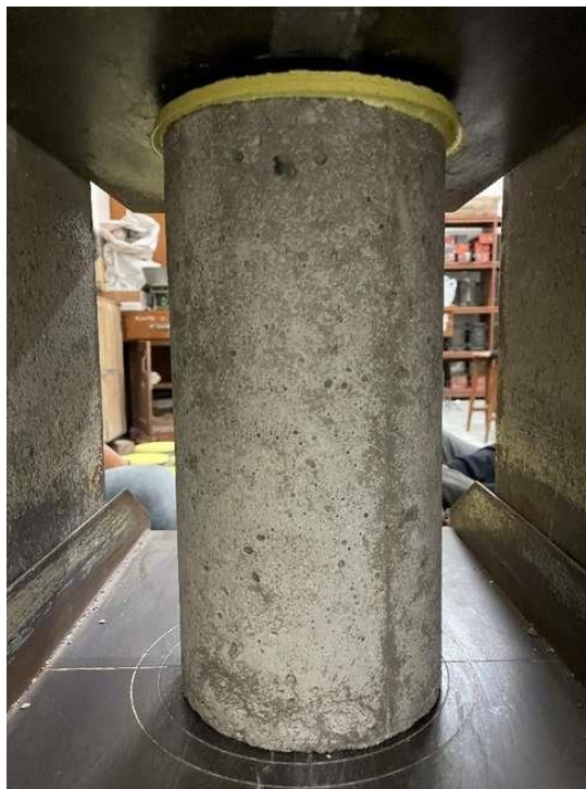
Gambar L-2.6 Pengujian Kuat Tekan
