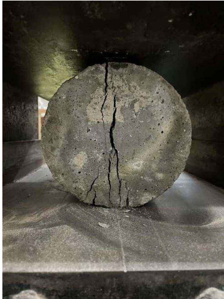
Gambar 4.2 Pengujian Kuat Tarik Belah Beton
