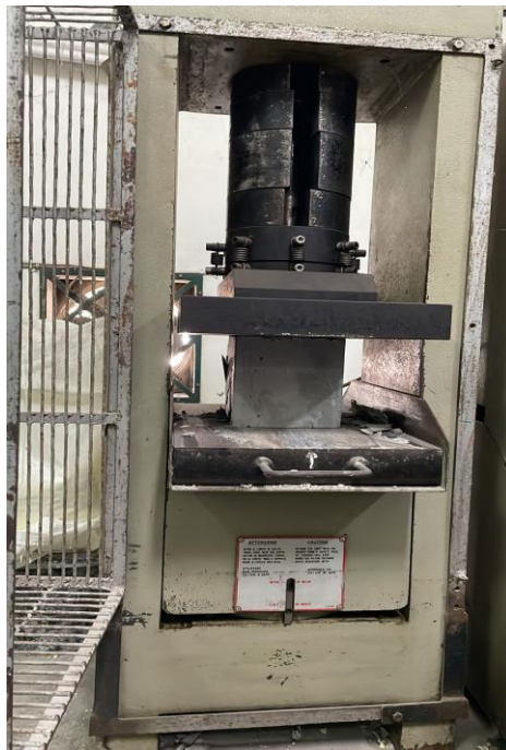
Gambar L-5.7 Pengujian Kuat Tekan Beton Menggunakan Compression Testing Machine
