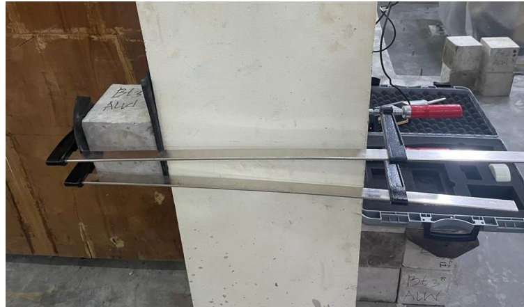
Gambar L-5.3 Penjepitan Benda Uji dengan Alat Clamp F
