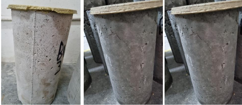
Gambar L-8.1.a Benda Uji Setelah Pengujian Kuat Tekan
