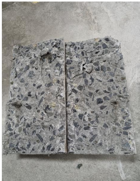
Gambar 5.13.b Variasi Beton Serat Ijuk dan Silica Fume Setelah Pengujian Kuat Tarik
