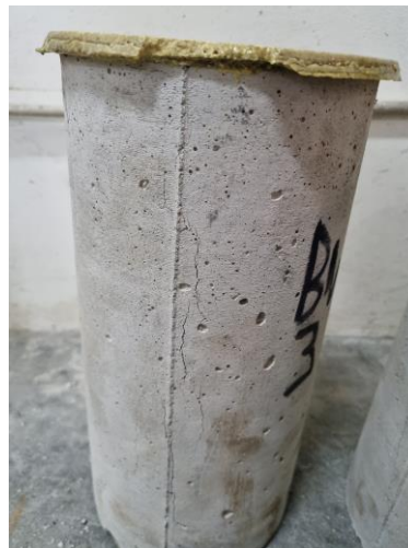
Gambar 5.10.a Variasi Beton Normal Setelah Pengujian Kuat Tekan
