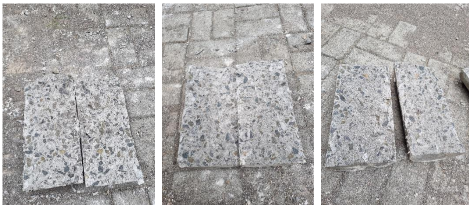
Gambar L-9.2.b Benda Uji Setelah Pengujian Kuat Tarik
