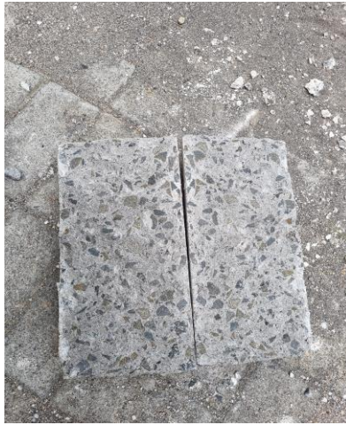
Gambar 5.13.a Variasi Beton Normal Setelah Pengujian Kuat Tarik
