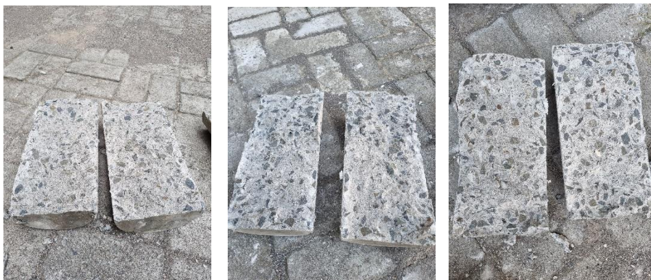
Gambar L-9.3.c Benda Uji Setelah Pengujian Kuat Tarik
