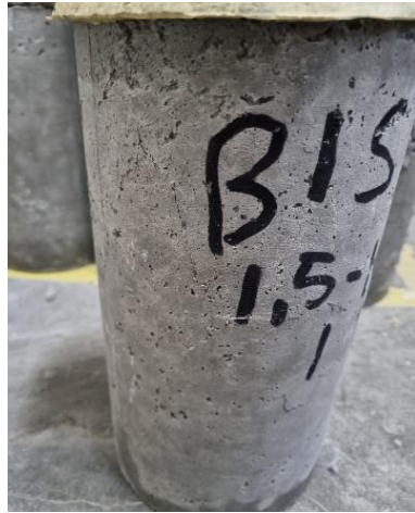
Gambar 5.10.b Variasi Beton Serat Ijuk dan Silica Fume Setelah Pengujian Kuat Tekan
