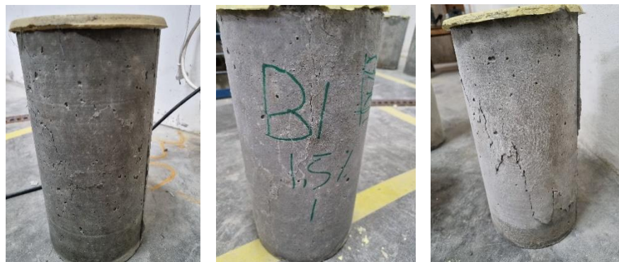
Gambar L-8.1.c Benda Uji Setelah Pengujian Kuat Tekan
