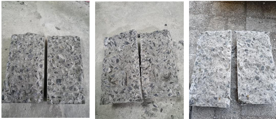
Gambar L-9.2.a Benda Uji Setelah Pengujian Kuat Tarik
