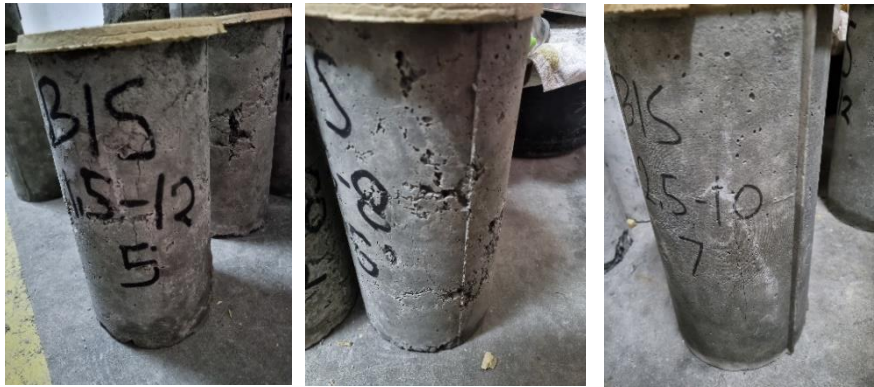
Gambar L-8.1.b Benda Uji Setelah Pengujian Kuat Tekan
