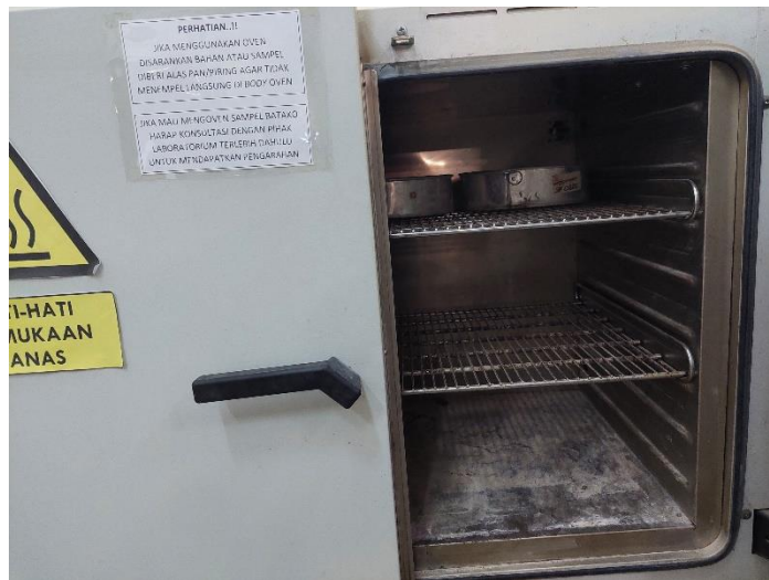
Lampiran 6.2 Memasukkan Agregat Ke Dalam Oven
