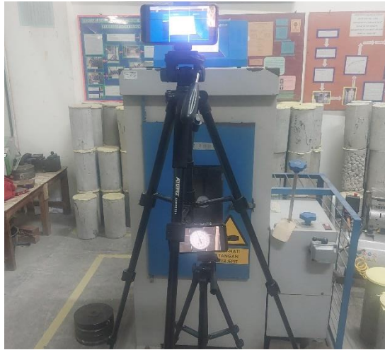
Gambar 5.20 Pengujian Modulus Elastisitas
