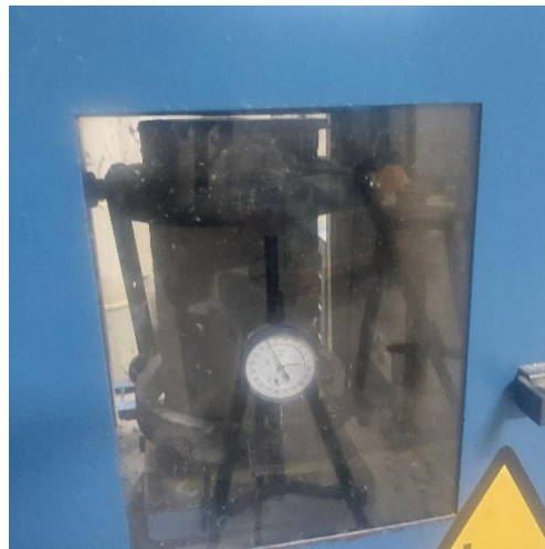
Gambar 5.12 Pengujian Kuat Tekan
