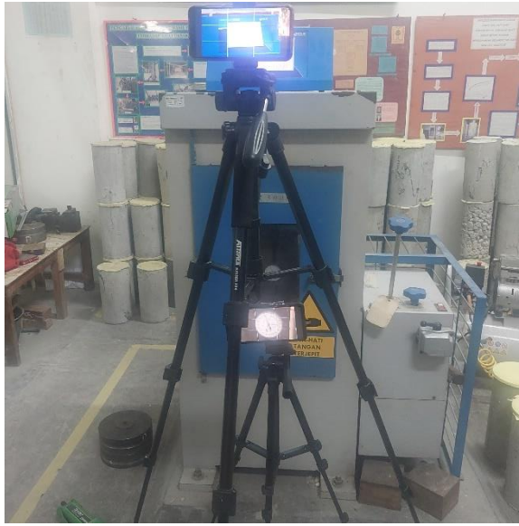
Lampiran 6.11 Pengujian Modulus Elastisitas Beton
