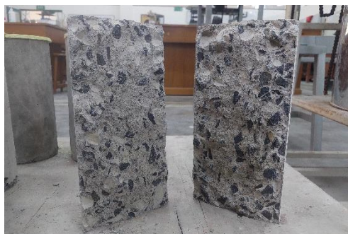
Gambar 5.16 Kondisi Benda Uji Setelah Pengujian Tarik Belah
