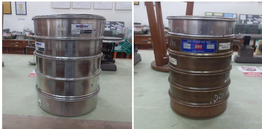
Gambar 4.5 Set Saringan Agregat Kasar dan Agregat Halus
