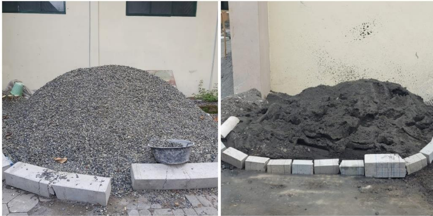
Gambar 4.2 Agregat Kasar dan Agregat Halus
