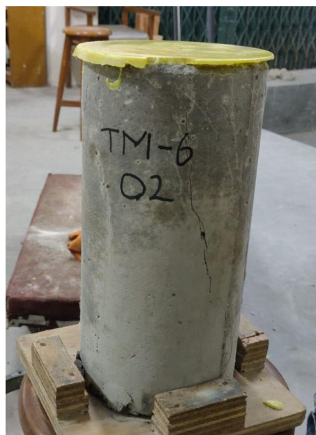
Gambar 5.13 Benda Uji Setelah Pengujian Tekan
