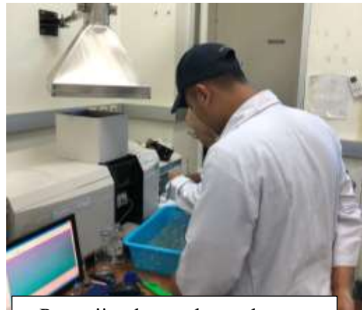
Pengujian logam berat dengan AAS
