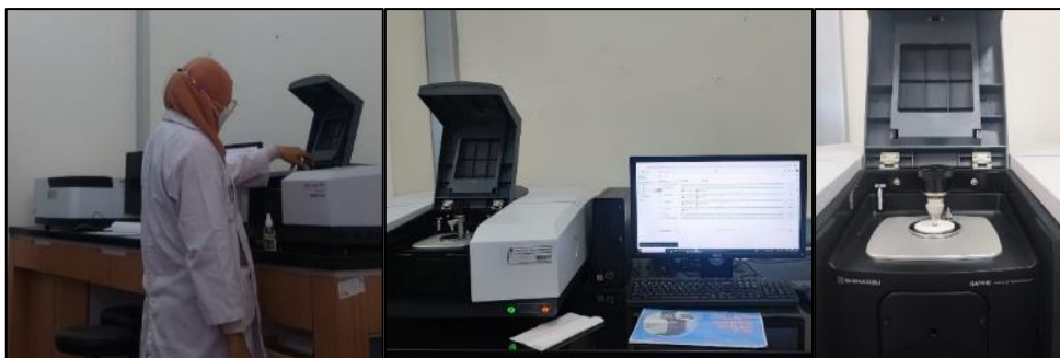
Gambar 3. 11 Pengamatan Sampel Menggunakan Fourier-Transform Infrared Spectroscopy (FT-IR)
