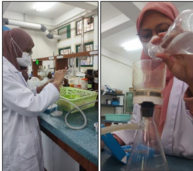
Gambar 3. 9 Proses Penyaringan Sampel
