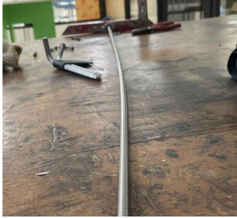
Gambar 4. 17 Kondisi Leadscrew sebelum diperbaiki
