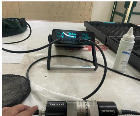
Gambar 4.19 Kalibrasi Alat Pengujian UPV
