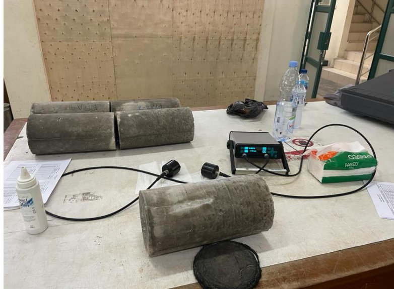
Gambar L-7.1 Persiapan Pengujian UPV Test
