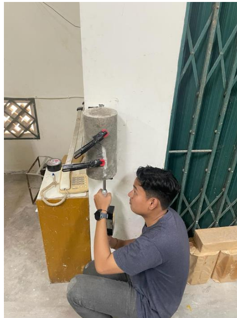
Gambar L-7.4 Proses Pengujian Hammer Test
