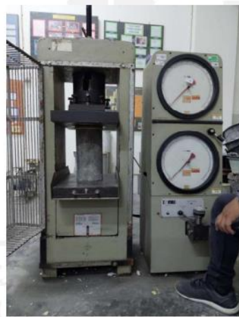
Gambar 3.9 Pengujian Kuat Tekan Beton
