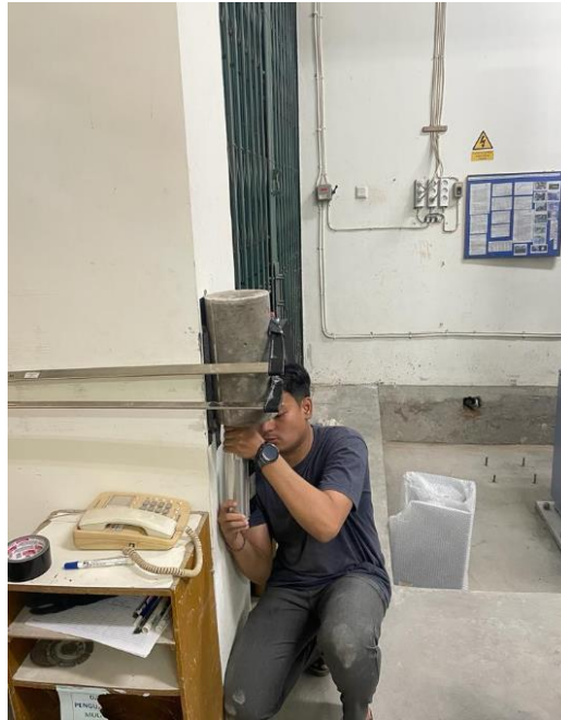
Gambar L-7.3 Penjepitan Benda Uji Menggunakan Clem F
