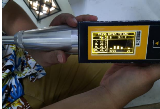
Gambar 4.21 Pembacaan Alat Concrete Hammer (Sumber: Dokumen Pribadi)
