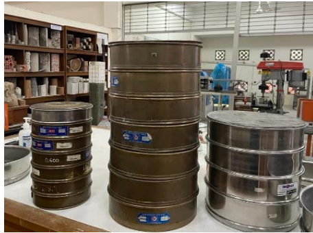
Gambar 4.1 Saringan Agregat (Sumber: Dokumentasi Pribadi)
