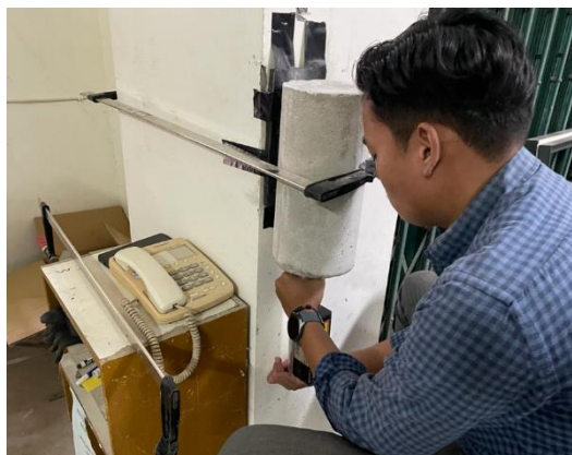
Gambar 4.20 Posisi Alat Concrete Hammer (Sumber: Dokumentasi Pribadi)
