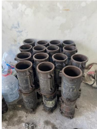
Gambar 4.7 Cetakan Beton Silinder (Sumber: Dokumentasi Pribadi)
