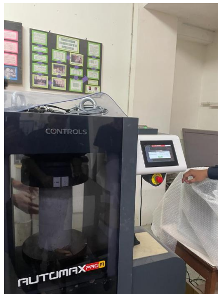
Gambar L-7.6 Proses Pengujian Compression Test
