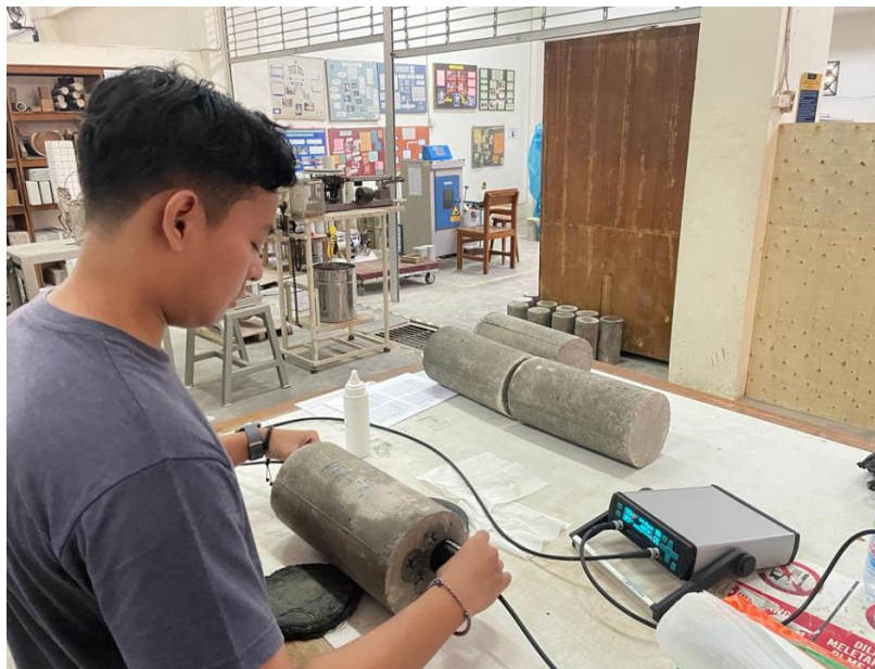
Gambar L-7.2 Proses Pengujian UPV Test
