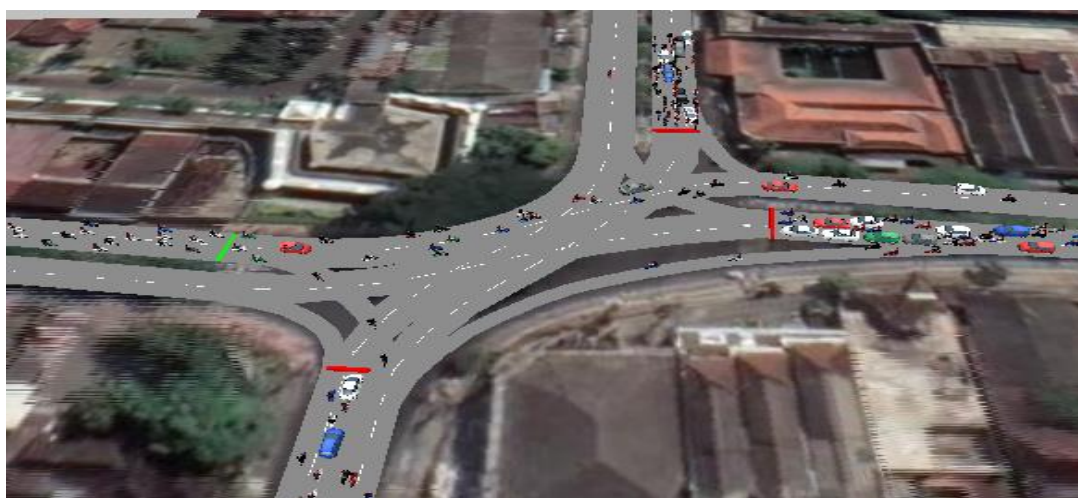
Gambar 5.32 Model Simpang Jukteng Wetan pada Simulasi VISSIM
