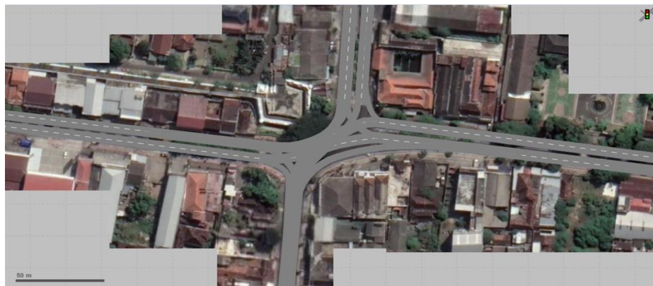
Gambar 5.20 Tampilan Link dan Connector Simpang Jukteng Wetan pada VISSIM
