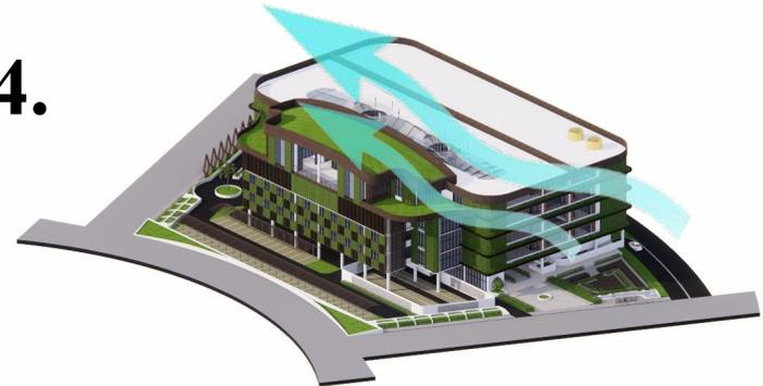
Koridor pejalan kaki pusat perbelanjaan menggunakan penghawaan alami. Angin yang datang dari selatan menuju utara dimanfaatkan masuk ke dalam bangunan yang direspon dengan atrium yang memanjang dari utara dan selatan.
