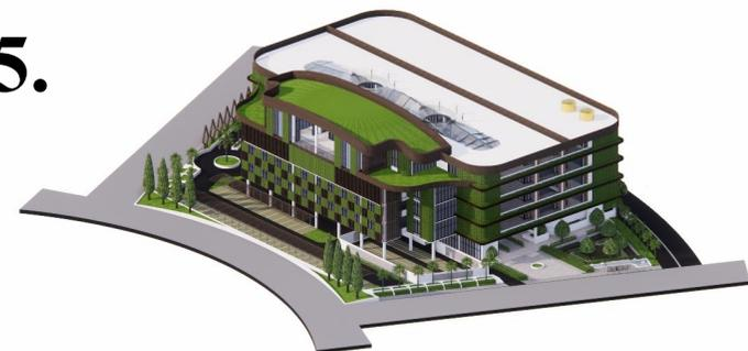
Vegetasi mengelilingi pusat perbelanjaan di masing-masing lantai untuk membantu mendinginkan koridor. Koridor dibuat mengelilingi sisi terluar pusat perbelanjaan untuk memasukan penghawaan alami.
