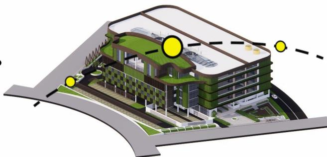
Bangunan merespon sinar matahari dengan membuat atap skylight untuk memasukan pencahayaan alami ke atrium. Sisi yang mendapat cahaya matahari langsung diberi vertikal shading.
