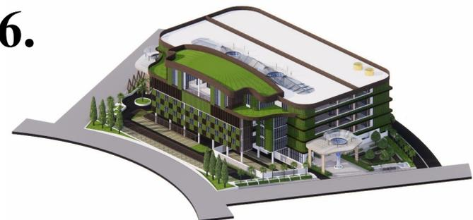
Pemilihan shading memanfaatkan vertikal garden untuk mendinginkan fasad di sisi barat karena banyak menggunakan material kaca. Shading juga dipasang di sisi timur untuk dengan teknik vertikal garden.
