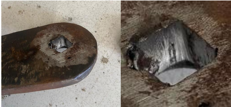
Gambar 4-28 Dudukan Dengan Lubang Yang Aus
