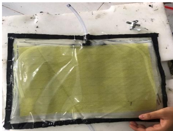
Gambar 3. 9 Proses Penyusunan Vacuum Bag
