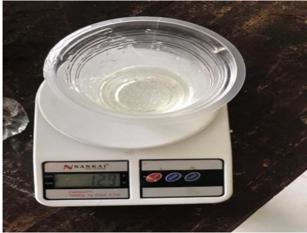
Gambar 3. 10 Proses Pencampuran Resin dan Hardener
