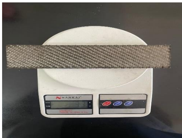
Gambar 3. 7 Spesimen Yang Sudah Ditempel Carbon
