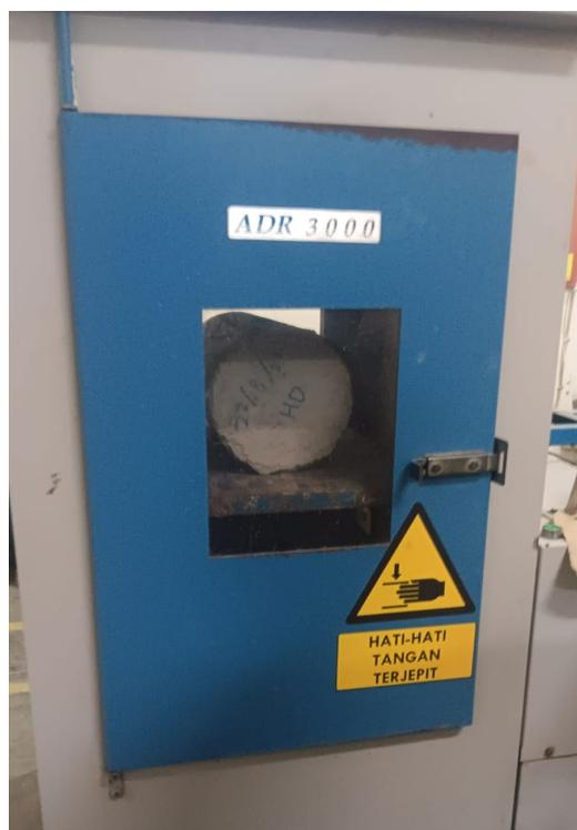
**Gambar L-10.7 Pengujian Kuat Tekan Beton**
