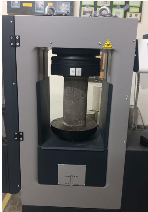
**Gambar L-10.6 Pengujian Kuat Tekan Beton**
