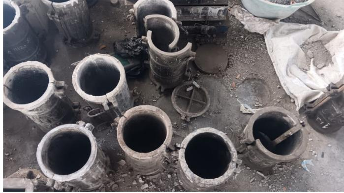
**Gambar L-9.1 Cetakan Beton Silinder**
