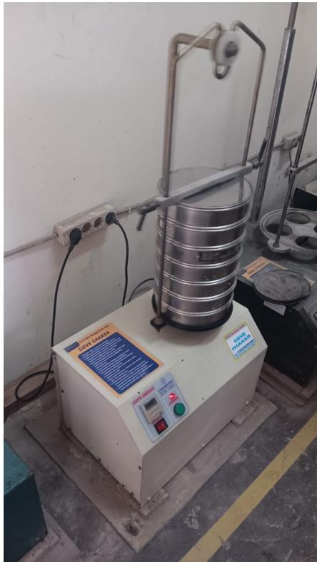
**Gambar L-9.9 Sieve Shaker Agregat Halus**
