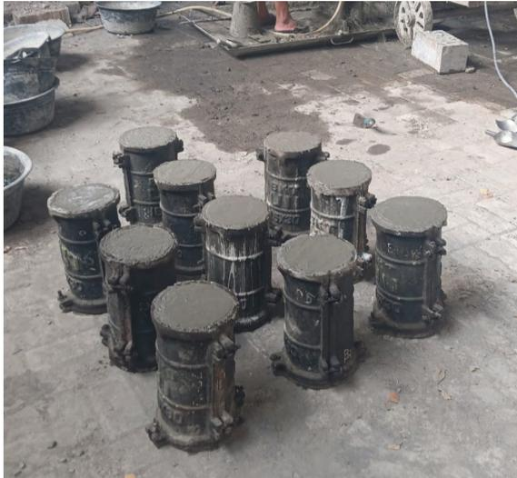
**Gambar L-10.3 Pencetakan Beton Segar**
