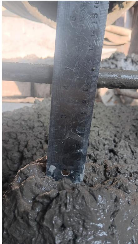
**Gambar L-10.2 Pengujian Nilai *Slump* Beton**
