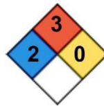
Gambar 2. 3 Hazard Diamond Etanol
