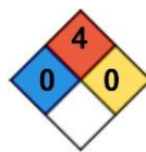
Gambar 2.2 Hazard Diamond Hidrogen
