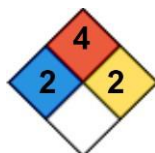
Gambar 2.1 Hazard Diamond Asetaldehid
