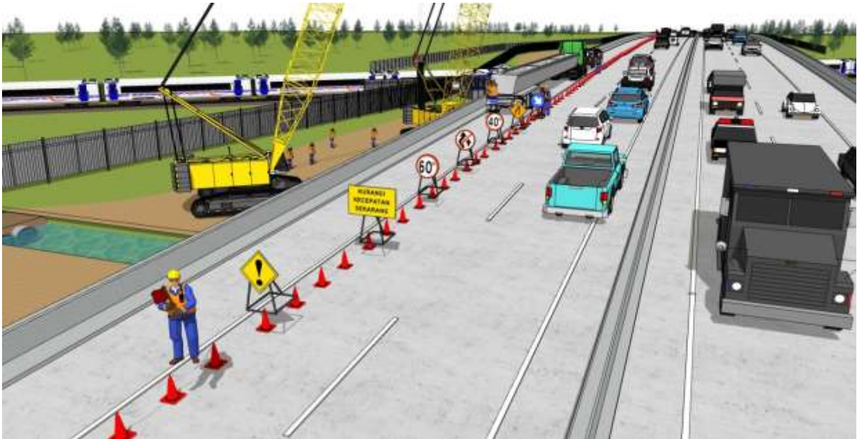
Gambar 14. Traffic Management Sebelum Area Pekerjaan
