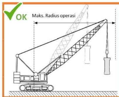
Gambar 5.6 Pengangkatan Segmen Balok Girder Dengan Crane Sumber: (AP3I, 2019)
