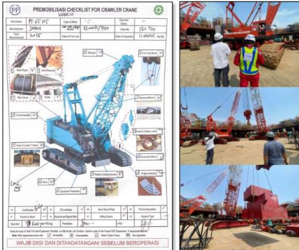
Gambar 5.42 Inspeksi Alat Berat Untuk Pekerjaan Erection Girder Oleh Biro QSHE PT.PP
