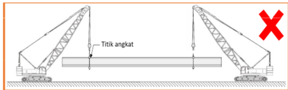
Gambar 5.32 Posisi Titik Angkat Balok yang Salah Sumber: (AP3I, 2019)
