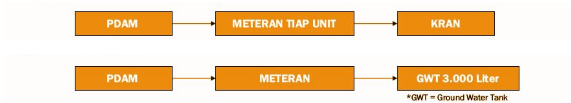
Gambar 4.7 Skema Penyediaan Air Bersih Sumber : Mahendra, 2023
